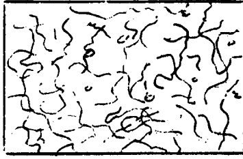
Fig.3.13 : Representación esquemática de "madejas (o Tangles)" de dislocaciones obtenidas de una micrografía electrónica.
