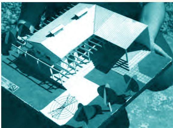
Fig. 5 - Estudio de sombras para un edificio realizado por alumnos, en base a una maqueta volumétrica que se ubica con su orientación coincidente con la del reloj solar horizontal, todo sobre un plano que pueda ser ubicado en cualquier posición.
