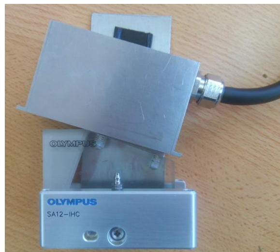
Figura 46. Montaje realizado para adaptar la zapata al transductor.
