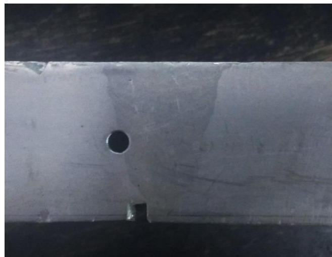
Figura 56. Probeta de acero inoxidable austenítico con un cordón de soldadura y entallas de referencia.
