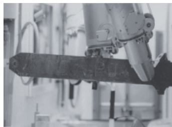
Combustibles para reactores de investigación Prototipo de elemento combustible con alta densidad de uranio
