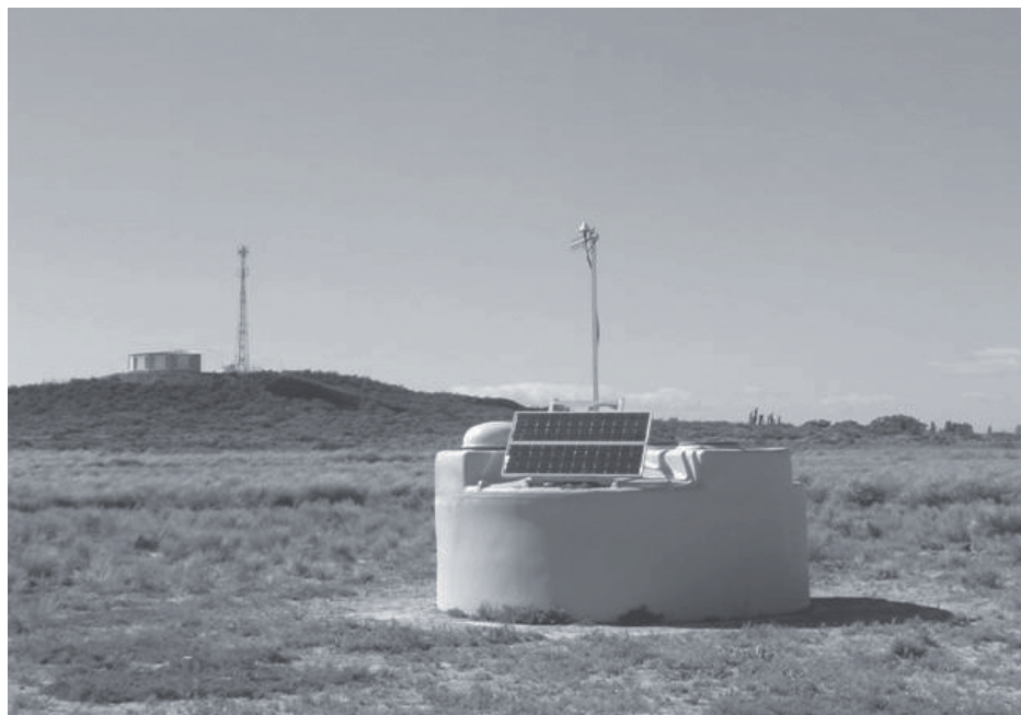
Fig. 2 - Detector de superficie del Observatorio Auger. Sobre el tanque de PVC, que alberga el agua hiper pura y los fototubos, se ven los paneles solares, el domo de la electrónica y la antena de telecomunicaciones.
