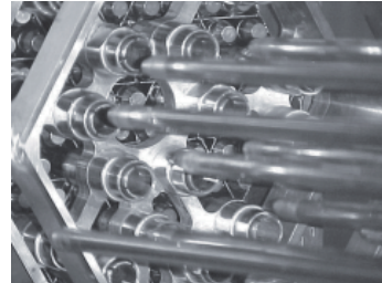
Proyecto CAREM Prototipo de elemento combustible
