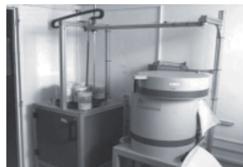
Laboratorio de Metrología de Radioisótopos Intercomparador de muestras - Detector de germanio hiperpuro Centro Atómico Ezeiza
