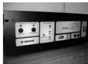
Prototipo de nariz electrónica para control de procesos industriales
