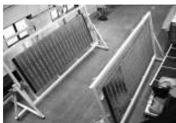
Proyecto Antena Radar de Apertura Sintética Módulos para ensayos de caracterización de radio frecuencia
