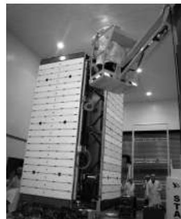
Proyecto ARAS Conjunto de antena completamente plegado
