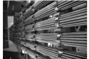
Elementos combustibles tipo PHWR para la Central Nuclear Atucha Unidad II en CONUAR S.A.
