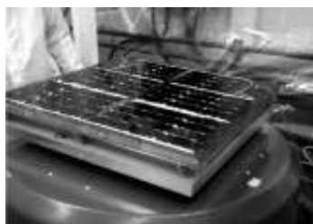
Proyecto Paneles solares - Fabricación de paneles solares para satélites Centro Atómico Constituyentes
