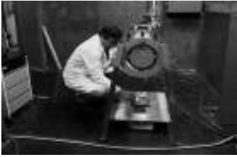
Ensayos No Destructivos Laboratorio de Radiografía Industrial Obtención de placa con equipo portátil Centro Atómico Constituyentes
