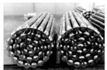
Elementos combustibles tipo CANDU para la Central Nuclear Embalse fabricado en CONUAR S.A.
