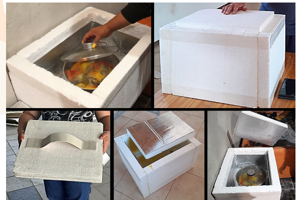
Fig. 1 - Caja térmica - Para el armado de sus cuatro lados, base y tapa se recomienda emplear seis planchas de telgopor (30 cm x 40 cm), de 5 cm de espesor. (*)
