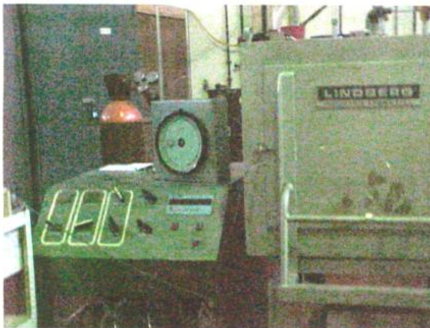
Fig. II.8 Panel de control de válvulas con manómetro (izq.) y horno (der.)
