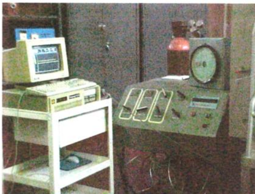
Fig. II.9 PC registrando los valores de la presión dentro de la probeta a lo largo del tiempo.
