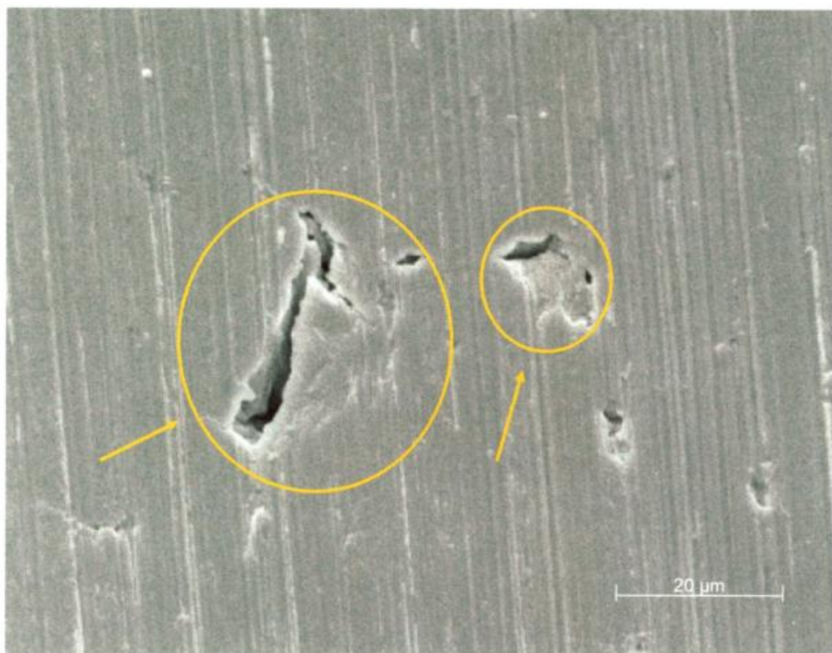
Fig. III.27 Superficie interior de vaina CAREM observada en SEM
