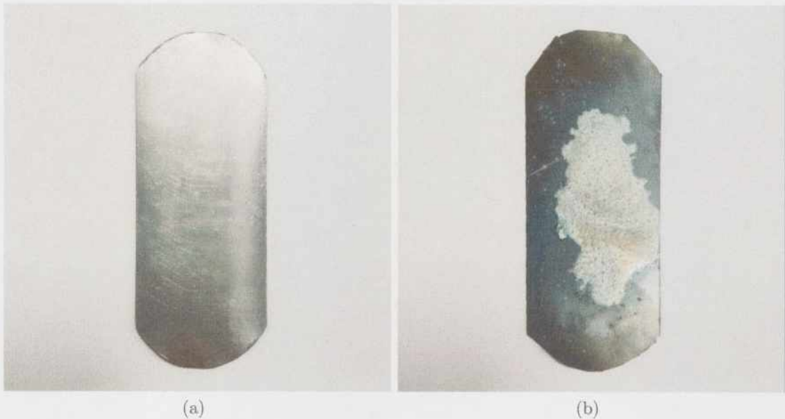
Figura 18: (a) Portablanco de Zircaloy-4 sin calentar y sin ^{nat}TeO_2 . (b) Portablanco de Zircaloy-4 calentado con ^{nat}TeO_2 .
