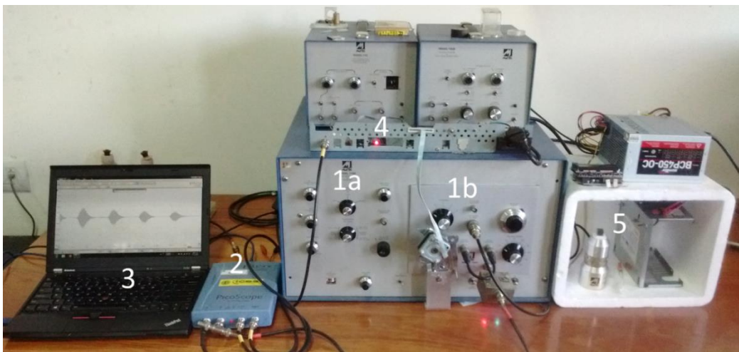
Figura 40. Esquema del sistema de medición. 1a. Generador pulsos cuadrados. 1b. Oscilador de alta frecuencia. 2. Osciloscopio Digital. 3. Computadora. 4. Microcontrolador. 5. Cámara de temperatura.
