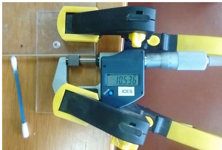
Figura 38. Esquema de medición de espesor.
