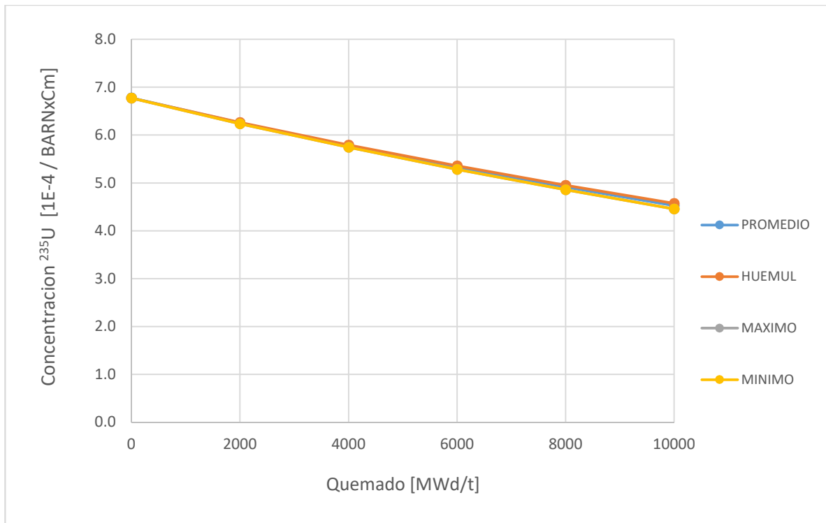
Figura 9. Variación de la concentración de ^{235}\text{U} en función del quemado en la celda sin veneno. Valor promedio de la celda.
