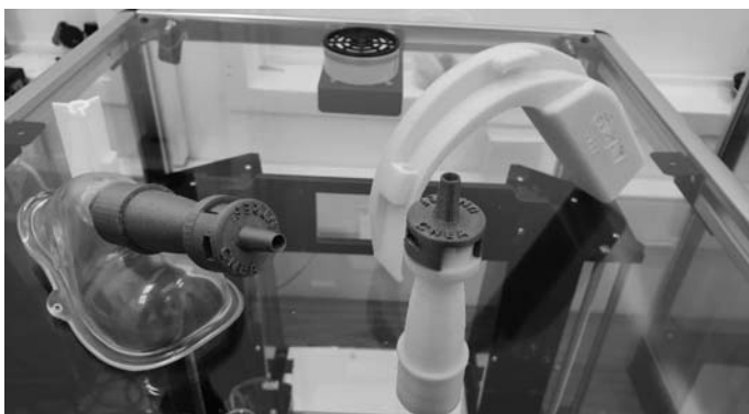
Válvula venturi de flujo variable. Laboratorio del Perfil Alar de la CNEA, Gerencia de Materiales, Centro Atómico Constituyentes, Provincia de Buenos Aires.
