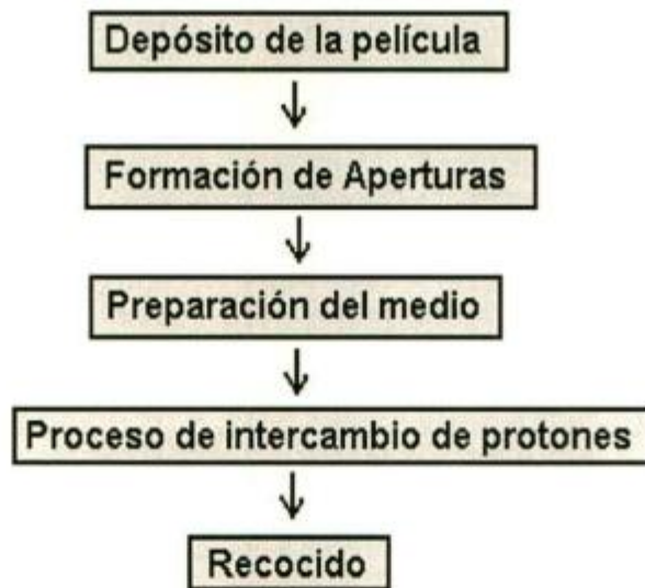
Figura 40: Pasos para la formación de una guía de ondas en el del método APE
