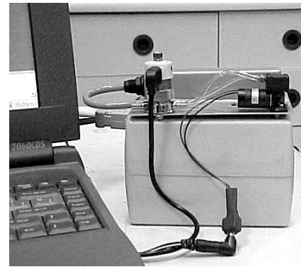
Prototipo de nariz electrónica desarrollada por CNEA-CITEFA con un array de 6 sensores MOS tipo MEMS
