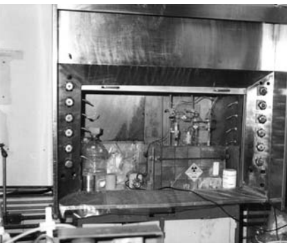
Instalación para ensayos en columna de materiales intercambiadores (CST) para la retención de ^{137}\text{Cs} a partir de corrientes de residuos de Mo, de media actividad
