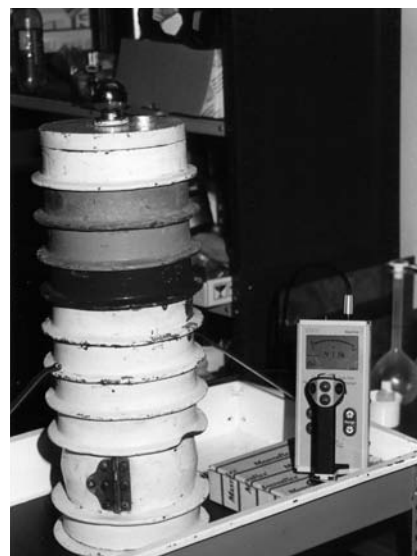
Castillo de plomo utilizado como blindaje para medición de gamma emisores.
