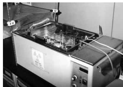
Equipo utilizado en los ensayos de contactado para la determinación de la isoterma de equilibrio.
