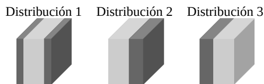
Figura 5.4: Esquema de tres objetos compuestos por la misma proporción de los mismos dos materiales ( K = 2 ), pero con diferente distribución. El espectro transmitido es el mismo en los tres casos. Se espera que las diferencias en los patrones de dispersión producidos por uno y otro objeto sean adecuadamente predichos por el modelo, empleando la misma matriz \mathbf{W} .
