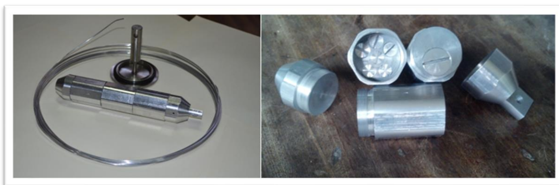
Figura 4-2: Portaprobetas de aluminio 6061 - Benchmark 1 .
