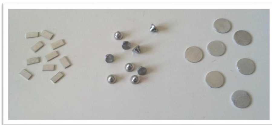
Figura 4-1: Probetas de acero inoxidable símil AISI 316L - Benchmark 1 .
