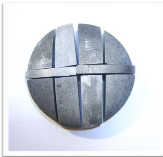
Figura 4-18: Botón seccionado de la aleación \text{Al}_{43}\text{Mo}_4\text{U}_6 (uranio depletado 0.2 %) – Benchmark 3-B .
