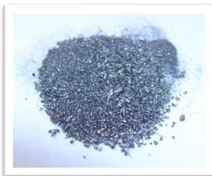
Figura 4-14: Polvo de aleación de U_3Si_5 (uranio depletado 0.2 %) – Benchmark 3-A .
