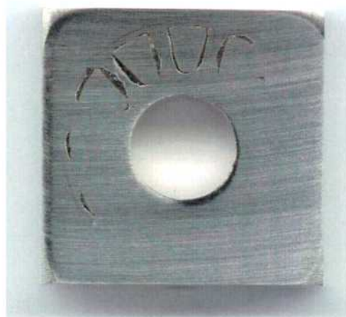
Figura 78: Imagen de la probeta PCA de la aleación C-22 en \text{CaCl}_2 5 mol/L a 100 °C luego de realizado el ensayo con el método PD-GS-PD para determinar E_{CO} . Ensayo N°3 Lado 1.
