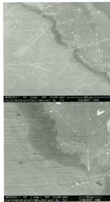
Figura 248: Imagen MEB de la aleación HYBRID-BC1 luego del ensayo PD-GS-PD en \text{CaCl}_2 5 mol/L a 100 °C. Ensayo N°1 Lado 2 (Figura 158). 300× (arriba) y 1200× (abajo)
