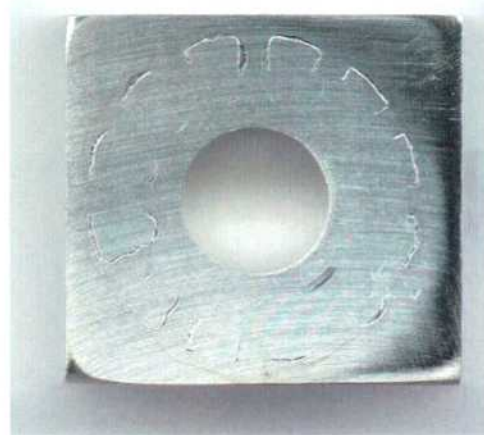
Figura 176: Imagen de la probeta PCA de la aleación HYBRID-BC1 en \text{CaCl}_2 5 mol/L a 70 °C luego de realizado el ensayo con el método PD-GS-PD para determinar E_{CO} . Ensayo 2 Lado 1.
