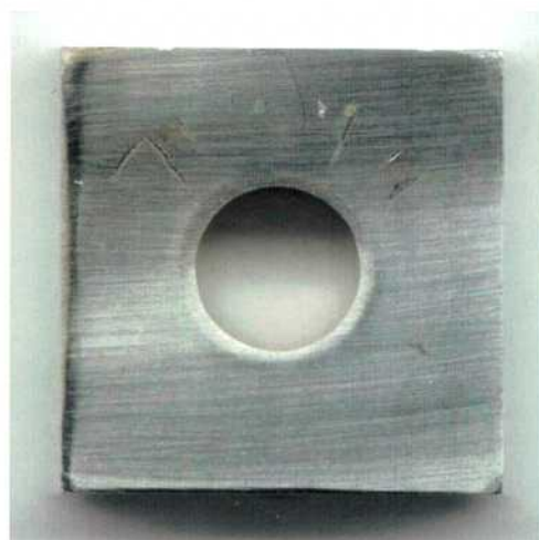
Figura 82: Imagen de la probeta PCA de la aleación C-22 en \text{CaCl}_2 5 mol/L a 90 °C luego de realizado el ensayo con el método PD-GS-PD para determinar E_{CO} . Ensayo N°2 Lado 1.
