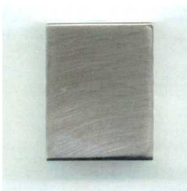
Figura 266: Imagen de probeta prismática de la aleación HYBRID-BC1 (MA) en HCl 1 mol/L correspondiente a mediciones de EIS y E_{CORR} a 70, 80, 90 y 100 °C. Medio desaireado. Lado 3.
