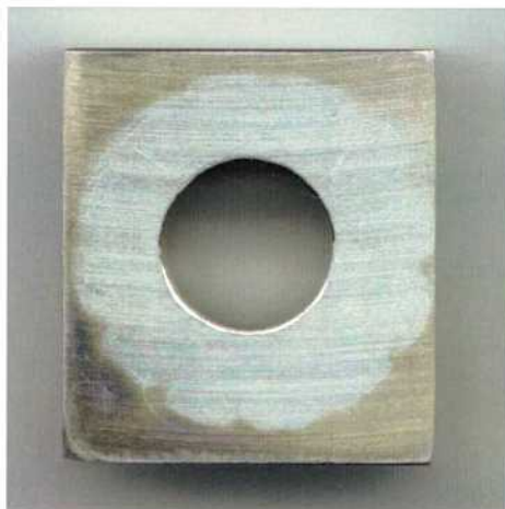
Figura 207: Imagen de la probeta PCA de la aleación HYBRID-BC1 en \text{CaCl}_2 5 mol/L a 60 °C luego de realizado el ensayo con el método PD-GS-PD en el que no se detectó corrosión localizada. Ensayo N°2 Lado 2.
