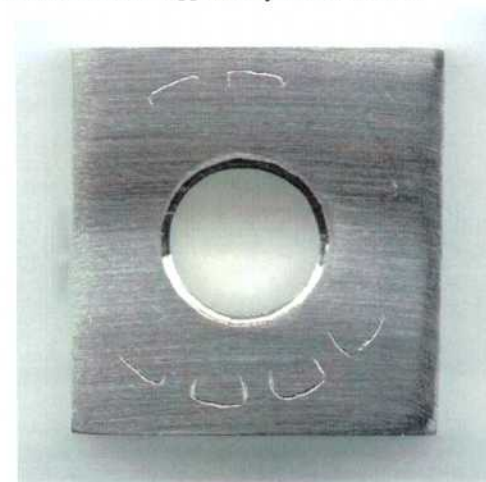
Figura 152: Imagen de la probeta PCA de la aleación C-22HS en \text{CaCl}_2 5 mol/L a 40 °C luego de realizado el ensayo con el método PD-GS-PD para determinar E_{CO} . Ensayo N°2 Lado 2.
