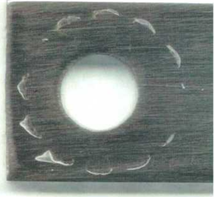
Figura 58: Imagen de la probeta MCA de la aleación 625 en \text{CaCl}_2 5 mol/L a 50 °C luego de realizado el ensayo con el método PD-GS-PD para determinar E_{CO} . Ensayo N°1 Lado 1.
