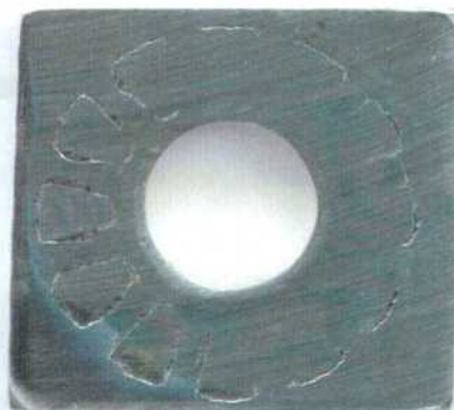
Figura 158: Imagen de la probeta PCA de la aleación HYBRID-BC1 en \text{CaCl}_2 5 mol/L a 100 °C luego de realizado el ensayo con el método PD-GS-PD para determinar E_{CO} . Ensayo 1 Lado 2.
