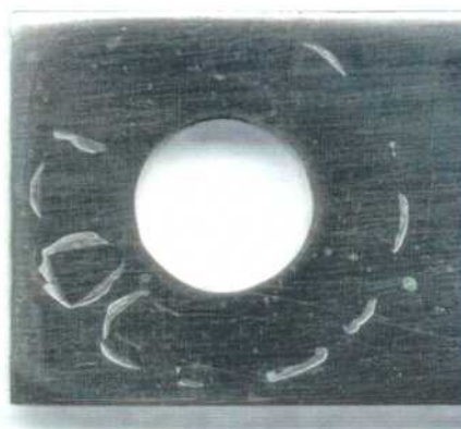
Figura 64: Imagen de la probeta MCA de la aleación 625 en \text{CaCl}_2 5 mol/L a 40 °C luego de realizado el ensayo con el método PD-GS-PD para determinar E_{CO} . Ensayo N°2 Lado 1.
