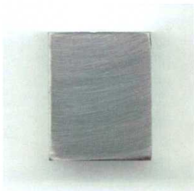
Figura 259: Imagen de probeta prismática de la aleación C-22 (MA) en HCl 3 mol/L correspondiente a mediciones de EIS y E_{CORR} a 30, 40, 50 y 60 °C. Medio desaireado. Lado 1.
