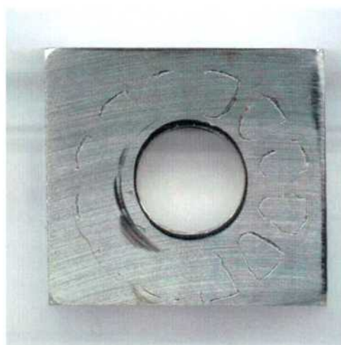
Figura 172: Imagen de la probeta PCA de la aleación HYBRID-BC1 en \text{CaCl}_2 5 mol/L a 80 °C luego de realizado el ensayo con el método PD-GS-PD para determinar E_{CO} . Ensayo 3 Lado 1.
