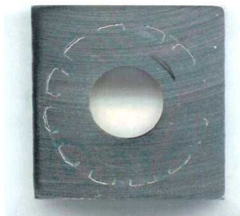
Figura 112: Imagen de la probeta PCA de la aleación C-22 en \text{CaCl}_2 5 mol/L a 40 °C luego de realizado el ensayo con el método PD-GS-PD para determinar E_{CO} . Ensayo N°3 Lado 1.
