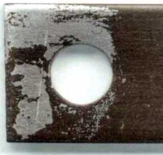
Figura 254: Imagen de la probeta MCA de la aleación 625 (MA) en HCl 1 mol/L correspondiente a mediciones de EIS y E_{CORR} a 70, 80, 90 y 100 °C. Medio desaireado. Lado 2.
