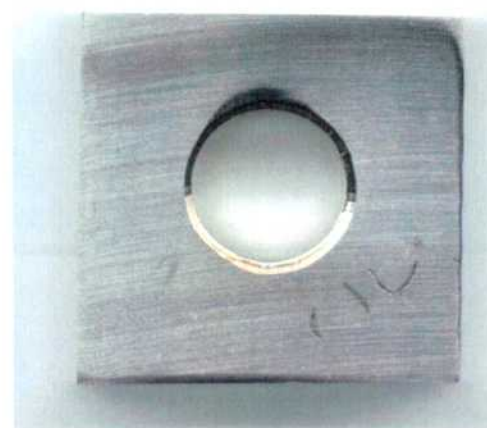
Figura 116: Imagen de la probeta PCA de la aleación C-22HS en \text{CaCl}_2 5 mol/L a 100 °C luego de realizado el ensayo con el método PD-GS-PD para determinar E_{CO} . Ensayo N°1 Lado 1.
