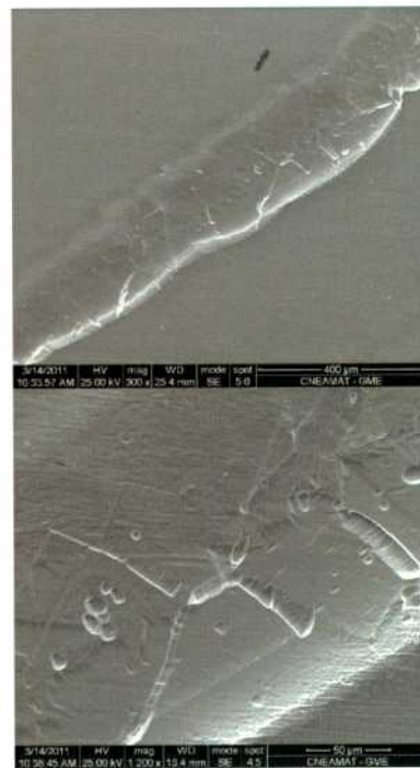
Figura 245: Imagen MEB de la aleación C-22HS luego del ensayo PD-GS-PD en \text{CaCl}_2 5 mol/L a 70 °C. Ensayo N°3 Lado 2 (Figura 138). 300× (arriba) y 1200× (abajo)
