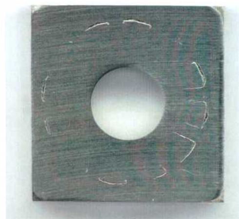
Figura 108: Imagen de la probeta PCA de la aleación C-22 en \text{CaCl}_2 5 mol/L a 50 °C luego de realizado el ensayo con el método PD-GS-PD para determinar E_{CO} . Ensayo N°5 Lado 1.
