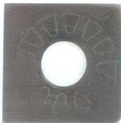
Figura 84: Imagen de la probeta PCA de la aleación C-22 en \text{CaCl}_2 5 mol/L a 80 °C luego de realizado el ensayo con el método PD-GS-PD para determinar E_{CO} . Ensayo N°1 Lado 2.
