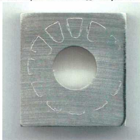
Figura 180: Imagen de la probeta PCA de la aleación HYBRID-BC1 en \text{CaCl}_2 5 mol/L a 60 °C luego de realizado el ensayo con el método PD-GS-PD para determinar E_{CO} . Ensayo 1 Lado 1.
