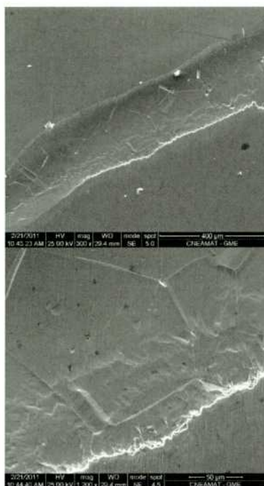
Figura 241: Imagen MEB de la aleación C-22 luego del ensayo PD-GS-PD en \text{CaCl}_2 5 mol/L a 50 °C. Ensayo N°5 Lado 1 (Figura 108). 300× (arriba) y 1200× (abajo)
