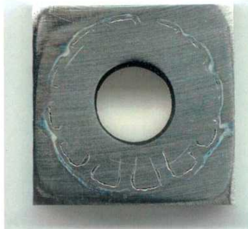
Figura 106: Imagen de la probeta PCA de la aleación C-22 en \text{CaCl}_2 5 mol/L a 50 °C luego de realizado el ensayo con el método PD-GS-PD para determinar E_{CO} . Ensayo N°4 Lado 2.
