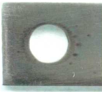
Figura 253: Imagen de la probeta MCA de la aleación 625 (MA) en HCl 1 mol/L correspondiente a mediciones de EIS y E_{CORR} a 30, 40, 50 y 60 °C. Medio desaireado. Lado 2.
