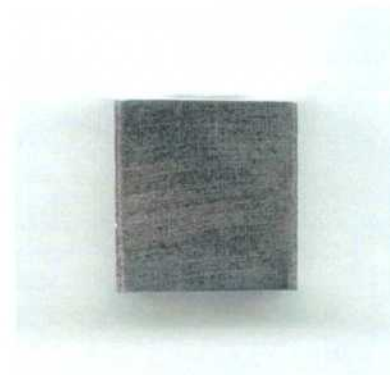
Figura 264: Imagen de probeta prismática de la aleación C-22HS (MA) en HCl 3 mol/L correspondiente a mediciones de EIS y E_{CORR} a 70, 80, 90 y 100 °C. Medio desaireado. Lado 1.
