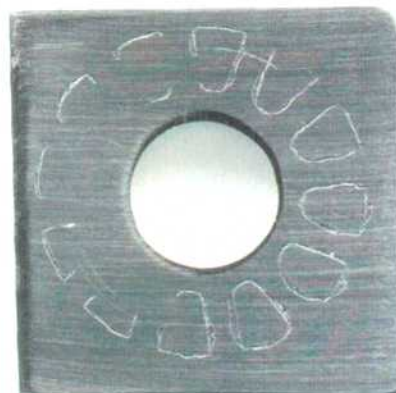
Figura 140: Imagen de la probeta PCA de la aleación C-22HS en \text{CaCl}_2 5 mol/L a 60 °C luego de realizado el ensayo con el método PD-GS-PD para determinar E_{CO} . Ensayo N°1 Lado 1.
