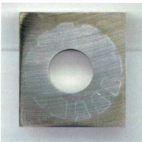
Figura 211: Imagen de la probeta PCA de la aleación HYBRID-BC1 en \text{CaCl}_2 5 mol/L a 50 °C luego de realizado el ensayo con el método PD-GS-PD en el que no se detectó corrosión localizada. Ensayo N°1 Lado 1.
