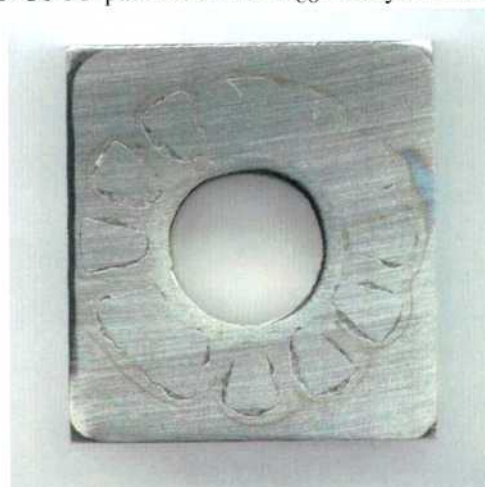
Figura 168: Imagen de la probeta PCA de la aleación HYBRID-BC1 en \text{CaCl}_2 5 mol/L a 90 °C luego de realizado el ensayo con el método PD-GS-PD para determinar E_{CO} . Ensayo 3 Lado 1.
