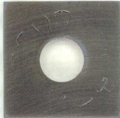
Figura 96: Imagen de la probeta PCA de la aleación C-22 en \text{CaCl}_2 5 mol/L a 60 °C luego de realizado el ensayo con el método PD-GS-PD para determinar E_{CO} . Ensayo N°2 Lado 1.
