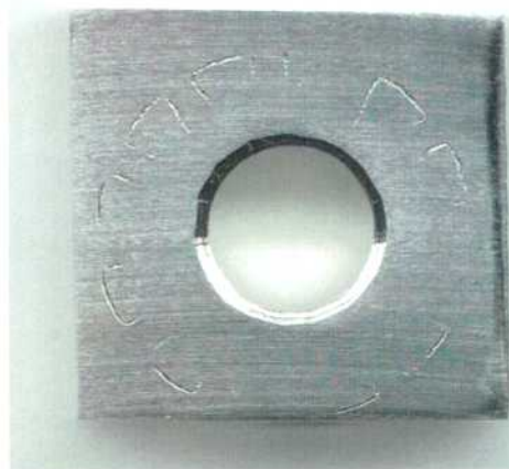
Figura 144: Imagen de la probeta PCA de la aleación C-22HS en \text{CaCl}_2 5 mol/L a 60 °C luego de realizado el ensayo con el método PD-GS-PD para determinar E_{CO} . Ensayo N°3 Lado 1.
