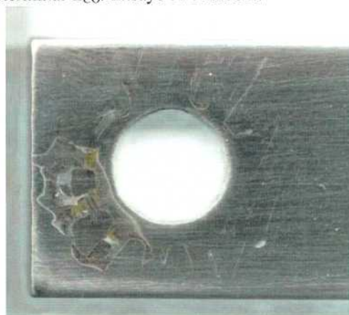
Figura 46: Imagen de la probeta MCA de la aleación 625 en \text{CaCl}_2 5 mol/L a 80 °C luego de realizado el ensayo con el método PD-GS-PD para determinar E_{CO} . Ensayo N°1 Lado 2.
