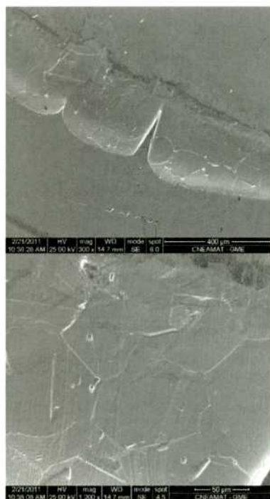
Figura 239: Imagen MEB de la aleación C-22 luego del ensayo PD-GS-PD en \text{CaCl}_2 5 mol/L a 70 °C. Ensayo N°1 Lado 2 (Figura 90). 300× (arriba) y 1200× (abajo)
