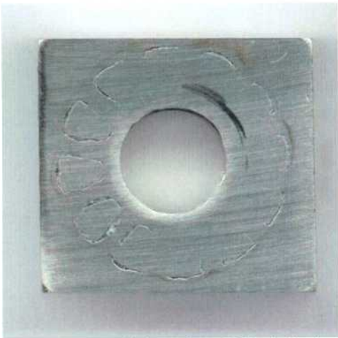
Figura 36: Imagen de la probeta PCA de la aleación HYBRID-BC1 en CaCl 2 5 mol/L a 80 °C luego de realizado el ensayo con el método PD-GS-PD para determinar E_{CO} . Ensayo N°2 Lado 2. \varnothing = 7,5 mm
