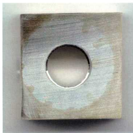
Figura 205: Imagen de la probeta PCA de la aleación C-22HS en \text{CaCl}_2 5 mol/L a 30 °C luego de realizado el ensayo con el método PD-GS-PD en el que no se detectó corrosión localizada. Ensayo N°3 Lado 1.
