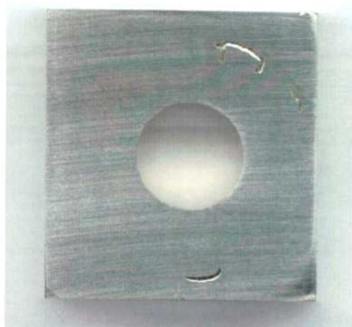
Figura 74: Imagen de la probeta PCA de la aleación C-22 en \text{CaCl}_2 5 mol/L a 100 °C luego de realizado el ensayo con el método PD-GS-PD para determinar E_{CO} . Ensayo N°1 Lado 2.
