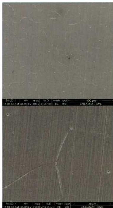
Figura 273: Imagen MEB de la aleación C-22HS (MA) en HCl 1 mol/L correspondiente a mediciones de EIS y E_{CORR} desde 30 a 100 °C. Lado 1 (Figura 262). 300× (arriba), 2400× (abajo)
