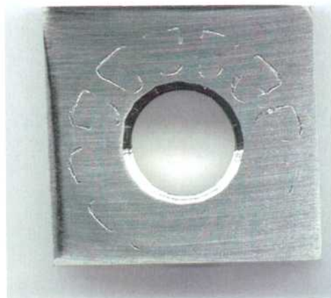
Figura 138: Imagen de la probeta PCA de la aleación C-22HS en \text{CaCl}_2 5 mol/L a 70 °C luego de realizado el ensayo con el método PD-GS-PD para determinar E_{CO} . Ensayo N°3 Lado 2.
