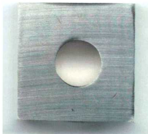
Figura 120: Imagen de la probeta PCA de la aleación C-22HS en \text{CaCl}_2 5 mol/L a 100 °C luego de realizado el ensayo con el método PD-GS-PD para determinar E_{CO} . Ensayo N°3 Lado 2.
