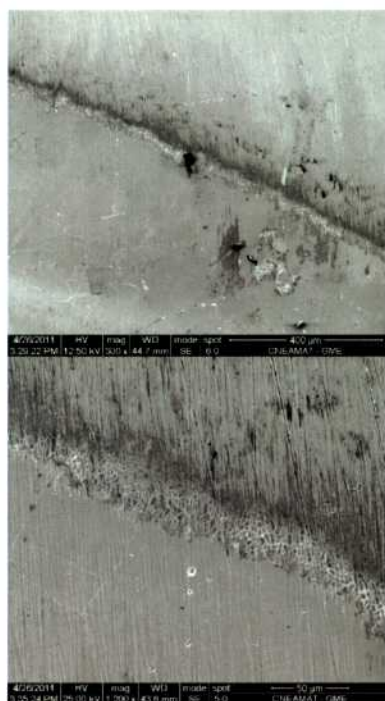
Figura 237: Imagen MEB de la aleación C-22 luego del ensayo PD-GS-PD en \text{CaCl}_2 5 mol/L a 100 °C. Ensayo N°2 Lado 2 (Figura 76). 300× (arriba) y 1200× (abajo)
