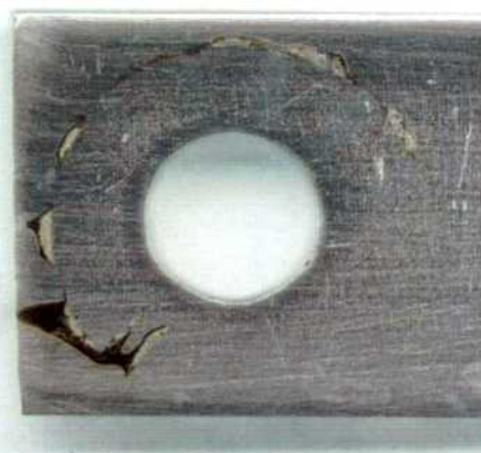
Figura 40: Imagen de la probeta MCA de la aleación 625 en \text{CaCl}_2 5 mol/L a 100 °C luego de realizado el ensayo con el método PD-GS-PD para determinar E_{CO} . Ensayo N°2 Lado 1.
