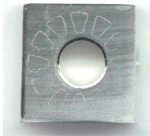
Figura 156: Imagen de la probeta PCA de la aleación C-22HS en \text{CaCl}_2 5 mol/L a 40 °C luego de realizado el ensayo con el método PD-GS-PD para determinar E_{CO} . Ensayo N°4 Lado 2.
