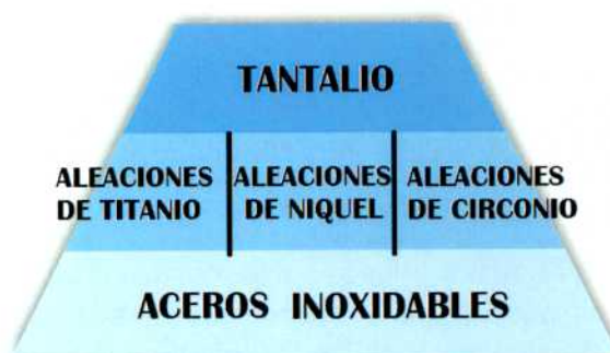
Figura 7: Comparación de la resistencia frente a la corrosión de las diferentes familias de aleaciones [22]. La resistencia a la corrosión disminuye hacia abajo.
