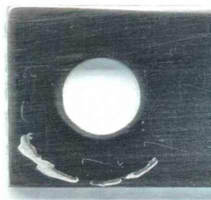
Figura 66: Imagen de la probeta MCA de la aleación 625 en \text{CaCl}_2 5 mol/L a 30 °C luego de realizado el ensayo con el método PD-GS-PD para determinar E_{CO} . Ensayo N°1 Lado 1.
