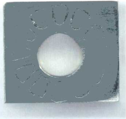
Figura 160: Imagen de la probeta PCA de la aleación HYBRID-BC1 en \text{CaCl}_2 5 mol/L a 100 °C luego de realizado el ensayo con el método PD-GS-PD para determinar E_{CO} . Ensayo 2 Lado 1.
