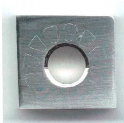
Figura 136: Imagen de la probeta PCA de la aleación C-22HS en \text{CaCl}_2 5 mol/L a 70 °C luego de realizado el ensayo con el método PD-GS-PD para determinar E_{CO} . Ensayo N°2 Lado 2.
