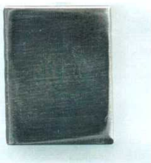
Figura 267: Imagen de probeta prismática de la aleación HYBRID-BC1 (MA) en HCl 3 mol/L correspondiente a mediciones de EIS y E_{CORR} a 30, 40, 50 y 60 °C. Medio desaireado. Lado 3.
