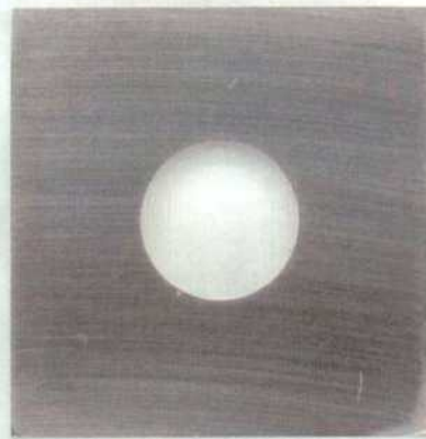
Figura 189: Imagen de la probeta PCA de la aleación C-22 en \text{CaCl}_2 5 mol/L a 60 °C luego de realizado el ensayo con el método PD-GS-PD en el que no se detectó corrosión localizada. Ensayo N°1 Lado 2.
