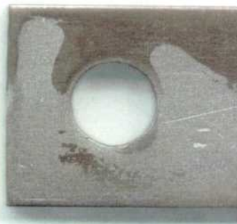
Figura 256: Imagen de la probeta MCA de la aleación 625 (MA) en HCl 3 mol/L correspondiente a mediciones de EIS y E_{CORR} a 70, 80, 90 y 100 °C. Medio desaireado. Lado 2.
