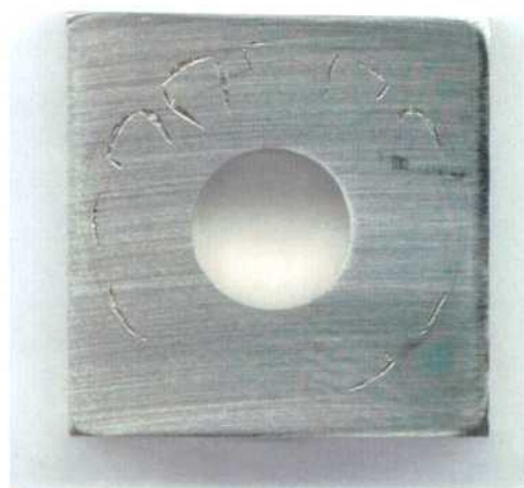
Figura 132: Imagen de la probeta PCA de la aleación C-22HS en \text{CaCl}_2 5 mol/L a 80 °C luego de realizado el ensayo con el método PD-GS-PD para determinar E_{CO} . Ensayo N°3 Lado 1.
