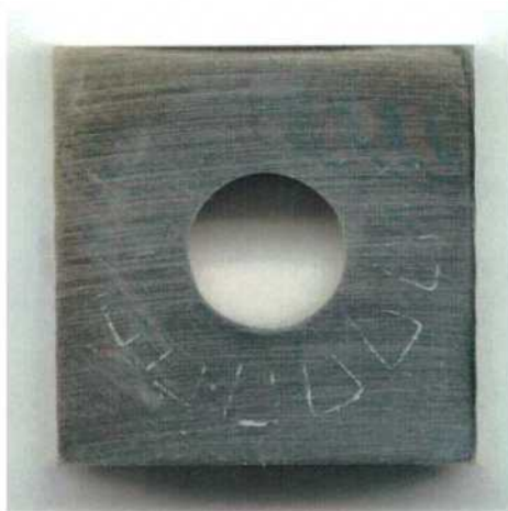
Figura 195: Imagen de la probeta PCA de la aleación C-22 en \text{CaCl}_2 5 mol/L a 30 °C luego de realizado el ensayo con el método PD-GS-PD en el que no se detectó corrosión localizada. Ensayo N°2 Lado 1.
