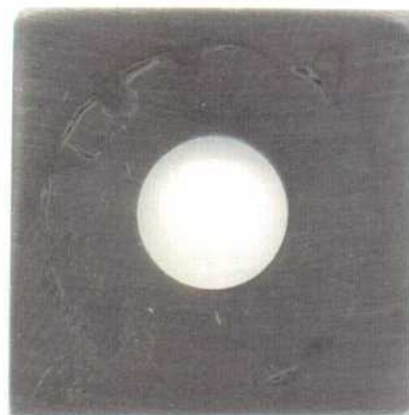
Figura 88: Imagen de la probeta PCA de la aleación C-22 en \text{CaCl}_2 5 mol/L a 80 °C luego de realizado el ensayo con el método PD-GS-PD para determinar E_{CO} . Ensayo N°3 Lado 2.
