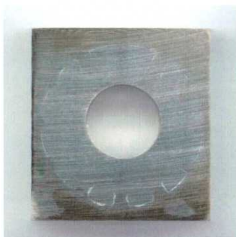
Figura 213: Imagen de la probeta PCA de la aleación HYBRID-BC1 en \text{CaCl}_2 5 mol/L a 50 °C luego de realizado el ensayo con el método PD-GS-PD en el que no se detectó corrosión localizada. Ensayo N°2 Lado 1.
