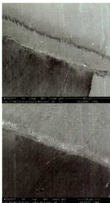
Figura 238: Imagen MEB de la aleación C-22 luego del ensayo PD-GS-PD en \text{CaCl}_2 5 mol/L a 90 °C. Ensayo N°2 Lado 1 (Figura 82). 300× (arriba) y 1200× (abajo)
