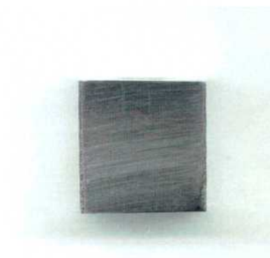
Figura 263: Imagen de probeta prismática de la aleación C-22HS (MA) en HCl 3 mol/L correspondiente a mediciones de EIS y E_{CORR} a 30, 40, 50 y 60 °C. Medio desaireado. Lado 1.
