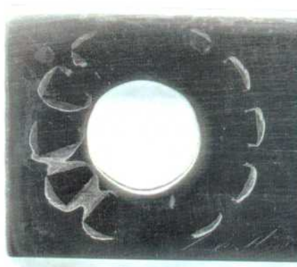
Figura 56: Imagen de la probeta MCA de la aleación 625 en \text{CaCl}_2 5 mol/L a 60 °C luego de realizado el ensayo con el método PD-GS-PD para determinar E_{CO} . Ensayo N°2 Lado 2.
