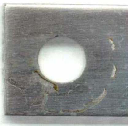
Figura 42: Imagen de la probeta MCA de la aleación 625 en \text{CaCl}_2 5 mol/L a 90 °C luego de realizado el ensayo con el método PD-GS-PD para determinar E_{CO} . Ensayo N°1 Lado 1.
