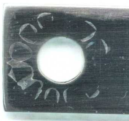
Figura 54: Imagen de la probeta MCA de la aleación 625 en \text{CaCl}_2 5 mol/L a 60 °C luego de realizado el ensayo con el método PD-GS-PD para determinar E_{CO} . Ensayo N°1 Lado 1.
