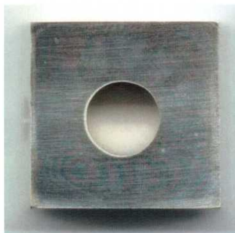
Figura 203: Imagen de la probeta PCA de la aleación C-22HS en \text{CaCl}_2 5 mol/L a 30 °C luego de realizado el ensayo con el método PD-GS-PD en el que no se detectó corrosión localizada. Ensayo N°2 Lado 1.
