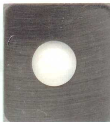
Figura 88: Imagen de la probeta PCA de la aleación C-22 en \text{CaCl}_2 5 mol/L a 80 °C luego de realizado el ensayo con el método PD-GS-PD para determinar E_{CO} . Ensayo N°3 Lado 2.
