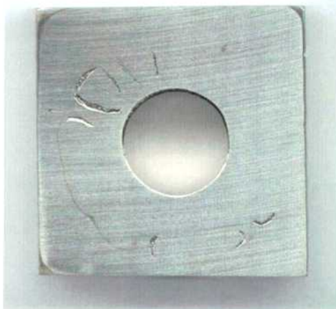
Figura 122: Imagen de la probeta PCA de la aleación C-22HS en \text{CaCl}_2 5 mol/L a 90 °C luego de realizado el ensayo con el método PD-GS-PD para determinar E_{CO} . Ensayo N°1 Lado 2.
