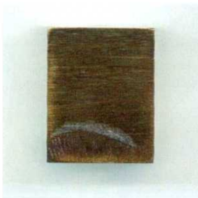
Figura 258: Imagen de probeta prismática de la aleación C-22 (MA) en HCl 1 mol/L correspondiente a mediciones de EIS y E_{CORR} a 70, 80, 90 y 100 °C. Medio desaireado. Lado 3.
