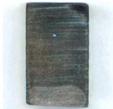
Figura 262: Imagen de probeta prismática de la aleación C-22HS (MA) en HCl 1 mol/L correspondiente a mediciones de EIS y E_{CORR} a 70, 80, 90 y 100 °C. Medio desaireado. Lado 1.
