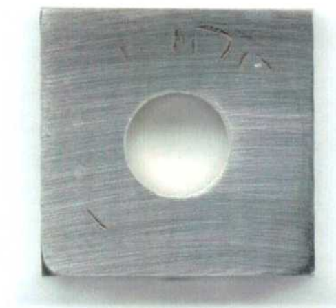
Figura 80: Imagen de la probeta PCA de la aleación C-22 en \text{CaCl}_2 5 mol/L a 100 °C luego de realizado el ensayo con el método PD-GS-PD para determinar E_{CO} . Ensayo N°4 Lado 2.
