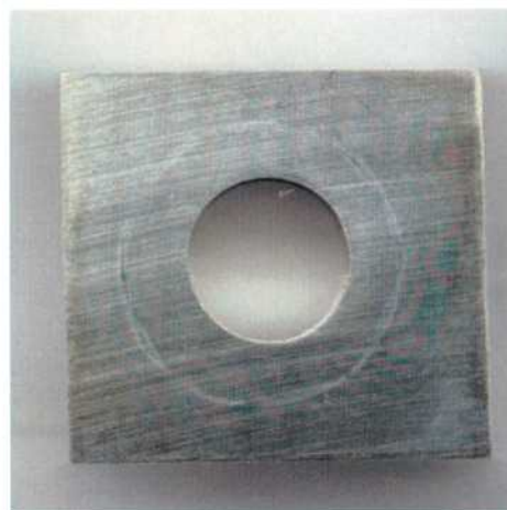
Figura 215: Imagen de la probeta PCA de la aleación HYBRID-BC1 en \text{CaCl}_2 5 mol/L a 50 °C luego de realizado el ensayo con el método PD-GS-PD en el que no se detectó corrosión localizada. Ensayo N°3 Lado 2.
