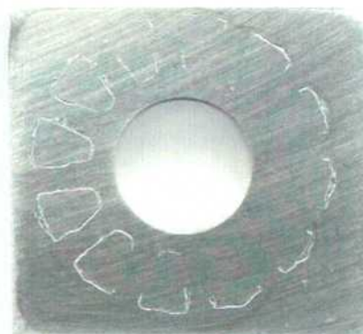
Figura 178: Imagen de la probeta PCA de la aleación HYBRID-BC1 en \text{CaCl}_2 5 mol/L a 70 °C luego de realizado el ensayo con el método PD-GS-PD para determinar E_{CO} . Ensayo 3 Lado 1.
