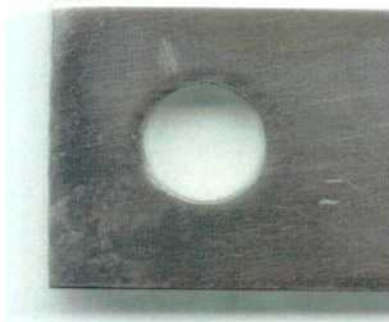
Figura 255: Imagen de la probeta MCA de la aleación 625 (MA) en HCl 3 mol/L correspondiente a mediciones de EIS y E_{CORR} a 30, 40, 50 y 60 °C. Medio desaireado. Lado 2.
