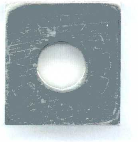
Figura 164: Imagen de la probeta PCA de la aleación HYBRID-BC1 en \text{CaCl}_2 5 mol/L a 90 °C luego de realizado el ensayo con el método PD-GS-PD para determinar E_{CO} . Ensayo 1 Lado 2.
