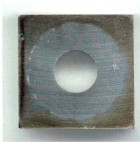
Figura 191: Imagen de la probeta PCA de la aleación C-22 en \text{CaCl}_2 5 mol/L a 40 °C luego de realizado el ensayo con el método PD-GS-PD en el que no se detectó corrosión localizada. Ensayo N°1 Lado 1.
