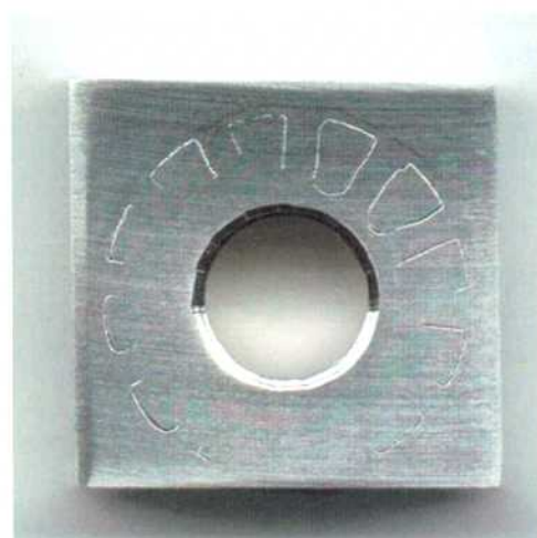
Figura 148: Imagen de la probeta PCA de la aleación C-22HS en \text{CaCl}_2 5 mol/L a 50 °C luego de realizado el ensayo con el método PD-GS-PD para determinar E_{CO} . Ensayo N°2 Lado 1.
