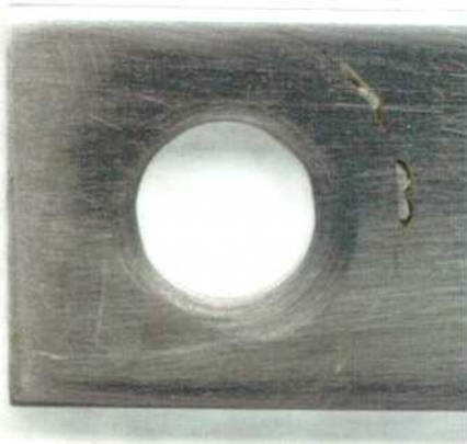
Figura 38: Imagen de la probeta MCA de la aleación 625 en \text{CaCl}_2 5 mol/L a 100 °C luego de realizado el ensayo con el método PD-GS-PD para determinar E_{CO} . Ensayo N°1 Lado 2.
