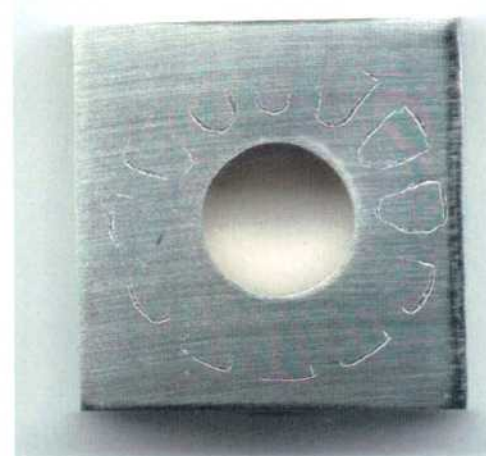
Figura 150: Imagen de la probeta PCA de la aleación C-22HS en \text{CaCl}_2 5 mol/L a 50 °C luego de realizado el ensayo con el método PD-GS-PD para determinar E_{CO} . Ensayo N°3 Lado 2.
