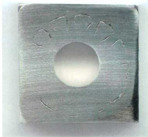
Figura 130: Imagen de la probeta PCA de la aleación C-22HS en \text{CaCl}_2 5 mol/L a 80 °C luego de realizado el ensayo con el método PD-GS-PD para determinar E_{CO} . Ensayo N°2 Lado 2.
