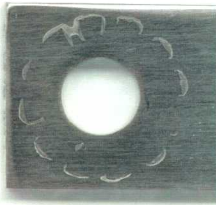
Figura 60: Imagen de la probeta MCA de la aleación 625 en \text{CaCl}_2 5 mol/L a 50 °C luego de realizado el ensayo con el método PD-GS-PD para determinar E_{CO} . Ensayo N°2 Lado 1.
