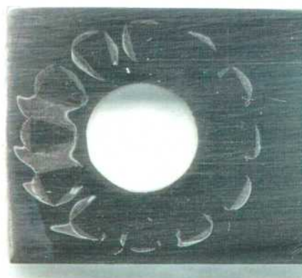
Figura 50: Imagen de la probeta MCA de la aleación 625 en \text{CaCl}_2 5 mol/L a 70 °C luego de realizado el ensayo con el método PD-GS-PD para determinar E_{CO} . Ensayo N°1 Lado 1.
