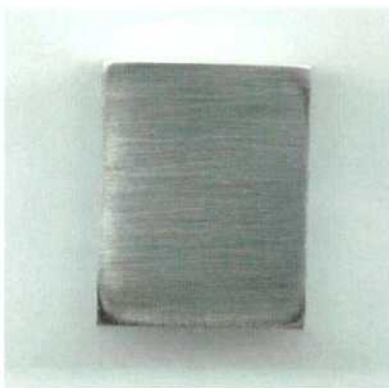
Figura 257: Imagen de probeta prismática de la aleación C-22 (MA) en HCl 1 mol/L correspondiente a mediciones de EIS y E_{CORR} a 30, 40, 50 y 60 °C. Medio desaireado. Lado 3.
