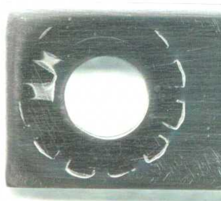
Figura 70: Imagen de la probeta MCA de la aleación 625 en \text{CaCl}_2 5 mol/L a 20 °C luego de realizado el ensayo con el método PD-GS-PD para determinar E_{CO} . Ensayo N°1 Lado 2.
