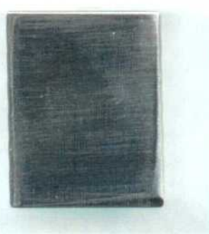
Figura 268: Imagen de probeta prismática de la aleación HYBRID-BC1 (MA) en HCl 3 mol/L correspondiente a mediciones de EIS y E_{CORR} a 70, 80, 90 y 100 °C. Medio desaireado. Lado 3.
