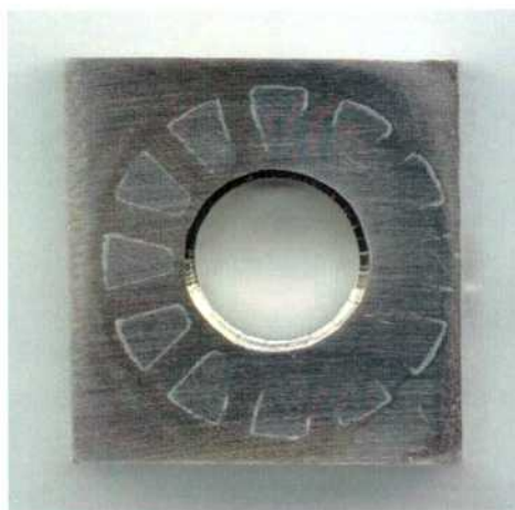
Figura 201: Imagen de la probeta PCA de la aleación C-22HS en \text{CaCl}_2 5 mol/L a 30 °C luego de realizado el ensayo con el método PD-GS-PD en el que no se detectó corrosión localizada. Ensayo N°1 Lado 1.
