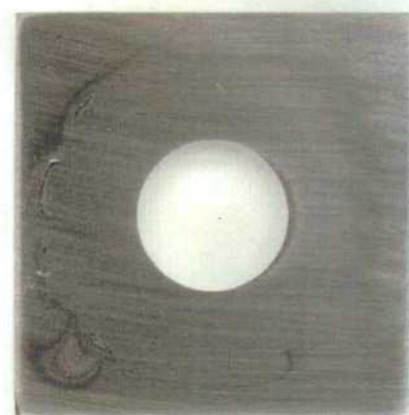
Figura 86: Imagen de la probeta PCA de la aleación C-22 en \text{CaCl}_2 5 mol/L a 80 °C luego de realizado el ensayo con el método PD-GS-PD para determinar E_{CO} . Ensayo N°2 Lado 2.
