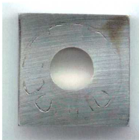
Figura 124: Imagen de la probeta PCA de la aleación C-22HS en \text{CaCl}_2 5 mol/L a 90 °C luego de realizado el ensayo con el método PD-GS-PD para determinar E_{CO} . Ensayo N°2 Lado 2.
