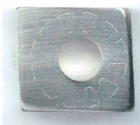
Figura 184: Imagen de la probeta PCA de la aleación HYBRID-BC1 en \text{CaCl}_2 5 mol/L a 60 °C luego de realizado el ensayo con el método PD-GS-PD para determinar E_{CO} . Ensayo 5 Lado 1.
