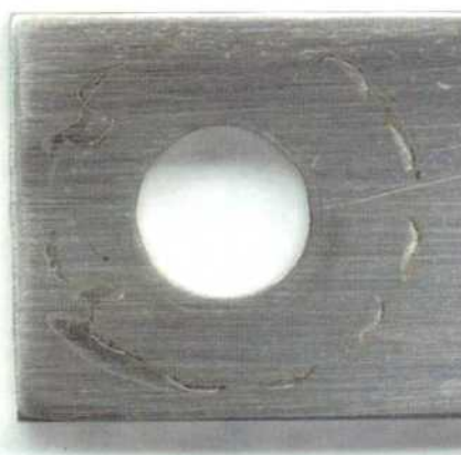
Figura 44: Imagen de la probeta MCA de la aleación 625 en \text{CaCl}_2 5 mol/L a 90 °C luego de realizado el ensayo con el método PD-GS-PD para determinar E_{CO} . Ensayo N°2 Lado 2.
