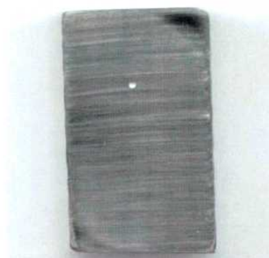
Figura 261: Imagen de probeta prismática de la aleación C-22HS (MA) en HCl 1 mol/L correspondiente a mediciones de EIS y E_{CORR} a 30, 40, 50 y 60 °C. Medio desaireado. Lado 1.
