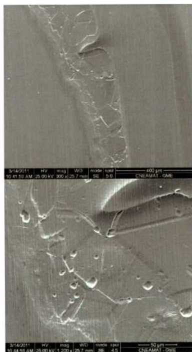
Figura 244: Imagen MEB de la aleación C-22HS luego del ensayo PD-GS-PD en \text{CaCl}_2 5 mol/L a 80 °C. Ensayo N°3 Lado 1 (Figura 132). 300× (arriba) y 1200× (abajo)
