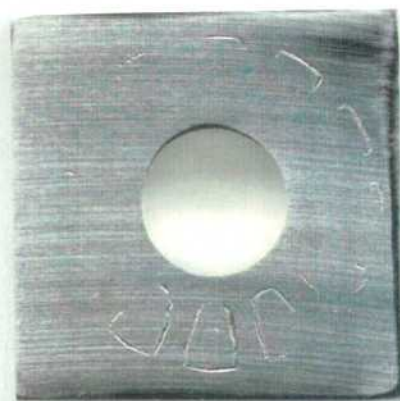
Figura 142: Imagen de la probeta PCA de la aleación C-22HS en \text{CaCl}_2 5 mol/L a 60 °C luego de realizado el ensayo con el método PD-GS-PD para determinar E_{CO} . Ensayo N°2 Lado 1.
