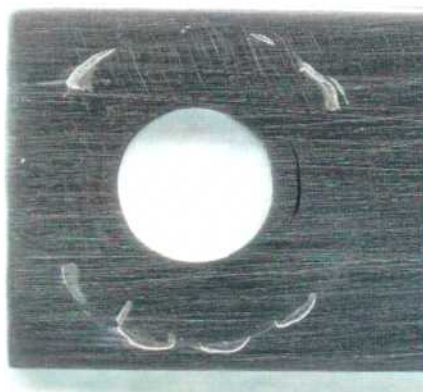
Figura 68: Imagen de la probeta MCA de la aleación 625 en \text{CaCl}_2 5 mol/L a 30 °C luego de realizado el ensayo con el método PD-GS-PD para determinar E_{CO} . Ensayo N°2 Lado 2.
