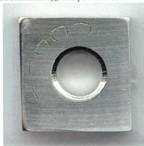
Figura 134: Imagen de la probeta PCA de la aleación C-22HS en \text{CaCl}_2 5 mol/L a 70 °C luego de realizado el ensayo con el método PD-GS-PD para determinar E_{CO} . Ensayo N°1 Lado 2.
