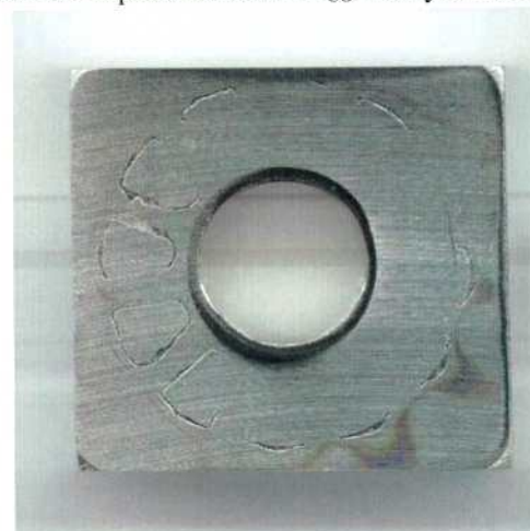
Figura 170: Imagen de la probeta PCA de la aleación HYBRID-BC1 en \text{CaCl}_2 5 mol/L a 80 °C luego de realizado el ensayo con el método PD-GS-PD para determinar E_{CO} . Ensayo 1 Lado 1.
