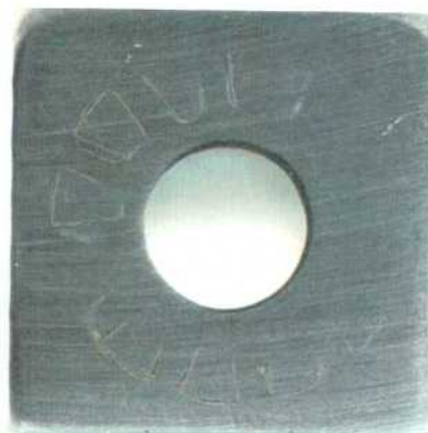
Figura 118: Imagen de la probeta PCA de la aleación C-22HS en \text{CaCl}_2 5 mol/L a 100 °C luego de realizado el ensayo con el método PD-GS-PD para determinar E_{CO} . Ensayo N°2 Lado 1.
