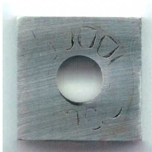
Figura 76: Imagen de la probeta PCA de la aleación C-22 en \text{CaCl}_2 5 mol/L a 100 °C luego de realizado el ensayo con el método PD-GS-PD para determinar E_{CO} . Ensayo N°2 Lado 2.
