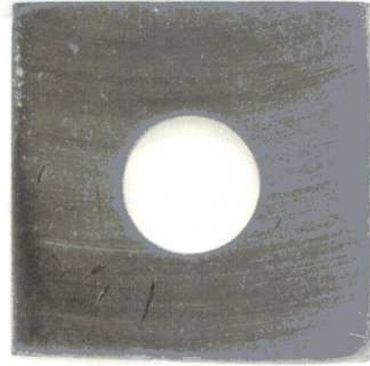
Figura 94: Imagen de la probeta PCA de la aleación C-22 en \text{CaCl}_2 5 mol/L a 70 °C luego de realizado el ensayo con el método PD-GS-PD para determinar E_{CO} . Ensayo N°3 Lado 2.
