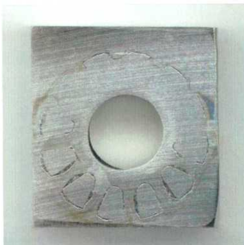
Figura 166: Imagen de la probeta PCA de la aleación HYBRID-BC1 en \text{CaCl}_2 5 mol/L a 90 °C luego de realizado el ensayo con el método PD-GS-PD para determinar E_{CO} . Ensayo 2 Lado 2.
