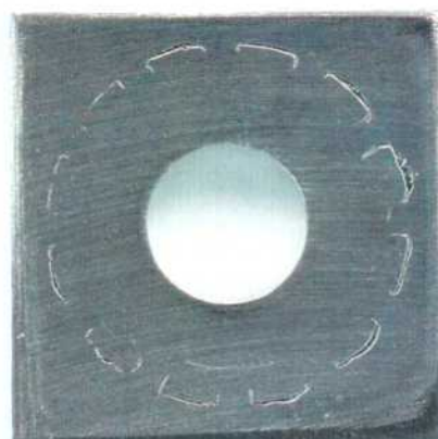
Figura 114: Imagen de la probeta PCA de la aleación C-22 en \text{CaCl}_2 5 mol/L a 40 °C luego de realizado el ensayo con el método PD-GS-PD para determinar E_{CO} . Ensayo N°4 Lado 2.
