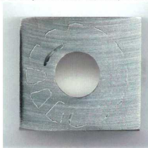
Figura 174: Imagen de la probeta PCA de la aleación HYBRID-BC1 en \text{CaCl}_2 5 mol/L a 70 °C luego de realizado el ensayo con el método PD-GS-PD para determinar E_{CO} . Ensayo 1 Lado 2.
