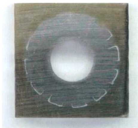
Figura 197: Imagen de la probeta PCA de la aleación C-22 en \text{CaCl}_2 5 mol/L a 30 °C luego de realizado el ensayo con el método PD-GS-PD en el que no se detectó corrosión localizada. Ensayo N°3 Lado 2.
