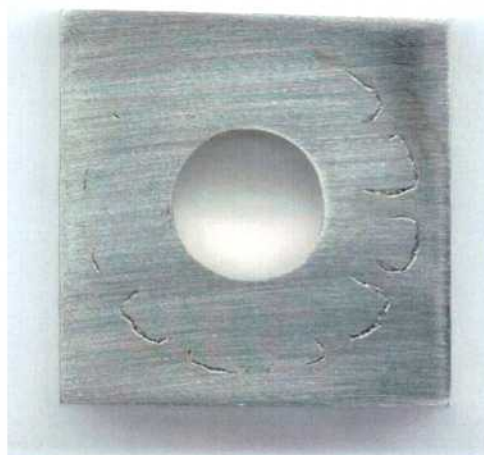
Figura 126: Imagen de la probeta PCA de la aleación C-22HS en \text{CaCl}_2 5 mol/L a 90 °C luego de realizado el ensayo con el método PD-GS-PD para determinar E_{CO} . Ensayo N°3 Lado 2.
