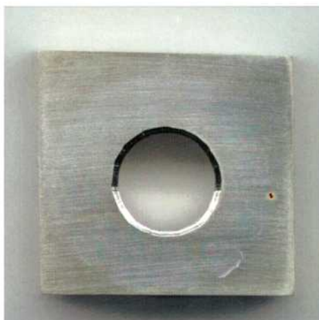
Figura 199: Imagen de la probeta PCA de la aleación C-22HS en \text{CaCl}_2 5 mol/L a 40 °C luego de realizado el ensayo con el método PD-GS-PD en el que no se detectó corrosión localizada. Ensayo N°1 Lado 1.
