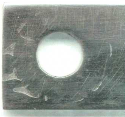
Figura 46: Imagen de la probeta MCA de la aleación 625 en \text{CaCl}_2 5 mol/L a 80 °C luego de realizado el ensayo con el método PD-GS-PD para determinar E_{CO} . Ensayo N°1 Lado 2.
