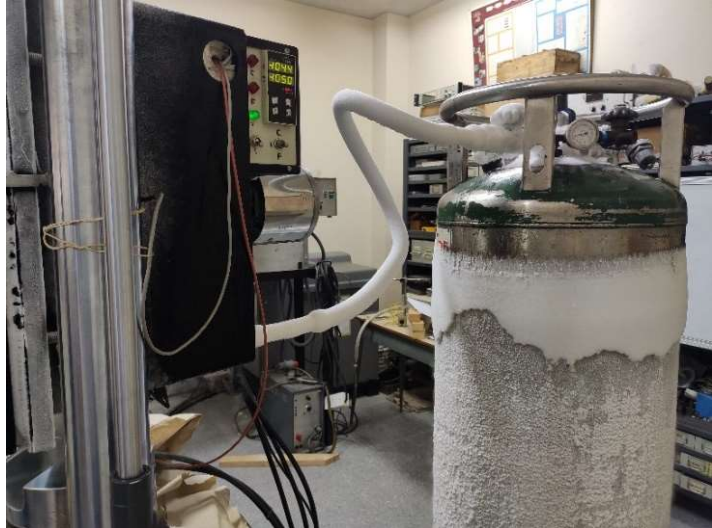
Figura 30 - Ensayo a bajas temperaturas con nitrógeno líquido
