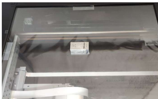
Figura 101 - Medición del bloque patrón de 16,50 mm
