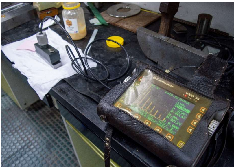
Figura 37 - Equipo de ultrasonido y palpador transversal
