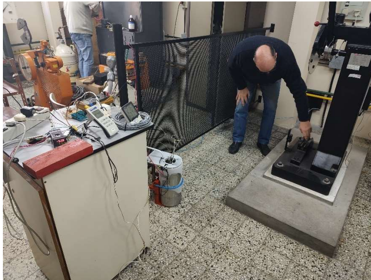
Figura 33 - Dispositivos e instrumentos para realizar los ensayos de Charpy
