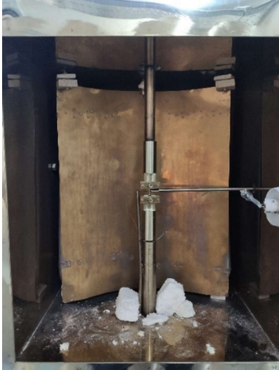
Figura 29 - Cámara ambiental y dispositivo para ensayos a altas y bajas temperaturas
