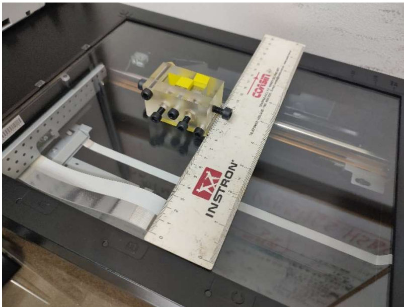
Figura 103 - Dispositivo para sujetar la probeta PCCv durante el escaneo
