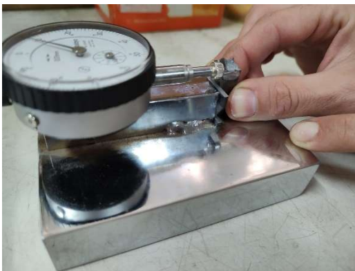
Figura 35 - Dispositivo para medición de entalla lateral
