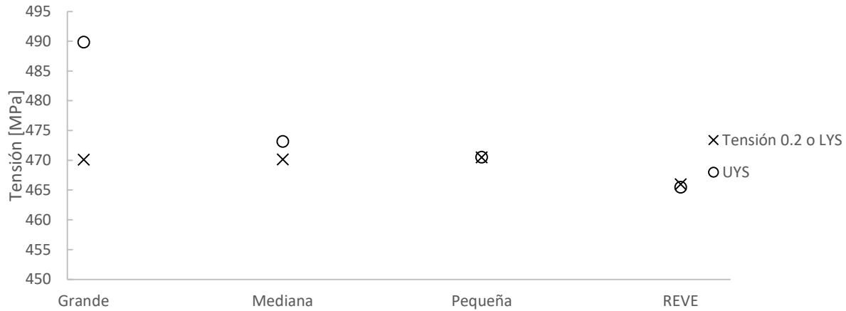
Figura 61 - Gráfico de tensiones de fluencia máxima, mínima o 0.2 según corresponda el caso
