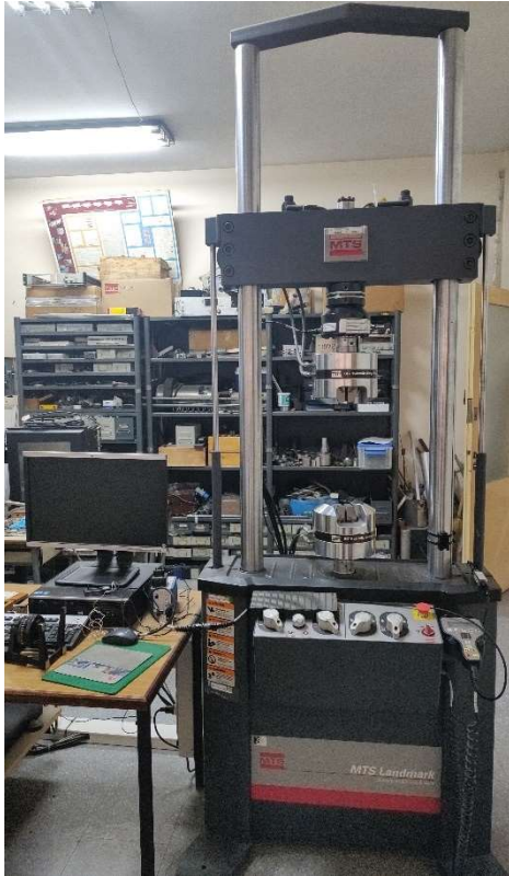
Figura 25 - Máquina utilizada para realizar los ensayos Figura 26 - Dispositivos construido para ensayar probetas tipo REVE
