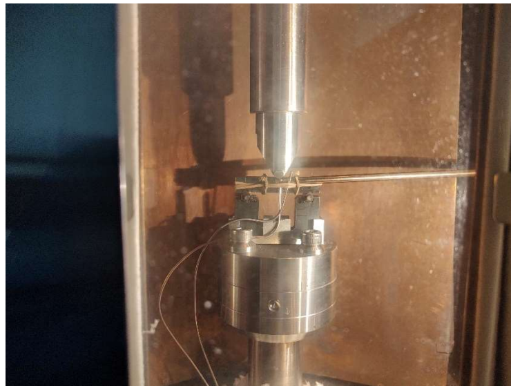
Figura 40 - Probeta PCCv montada sobre los dispositivos
