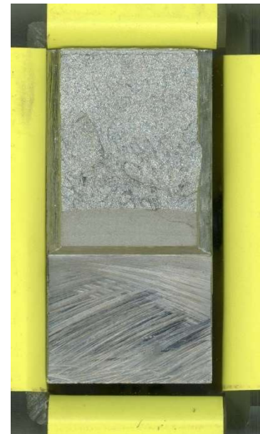
Figura 104 - Escaneo de la superficie de fractura de una probeta 0.65T
