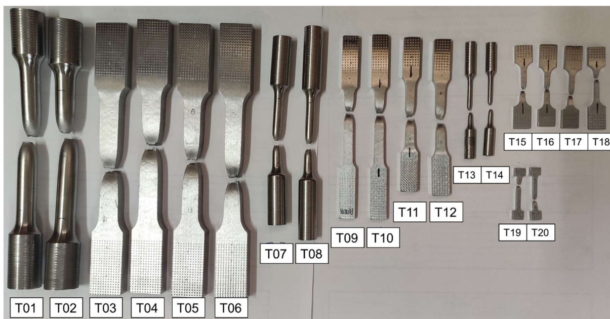
Figura 28 - Probetas de comparativa en tracción ensayadas a temperatura ambiente
