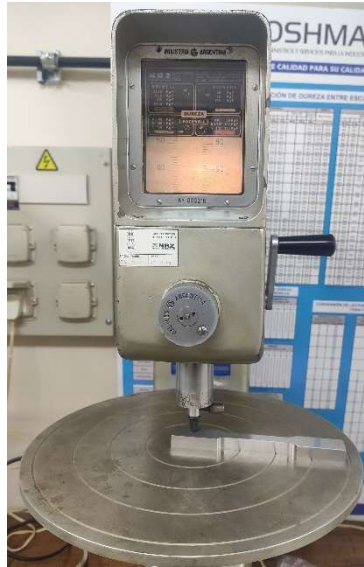
Figura 24 - Durómetro Galileo utilizado para los ensayos de dureza
