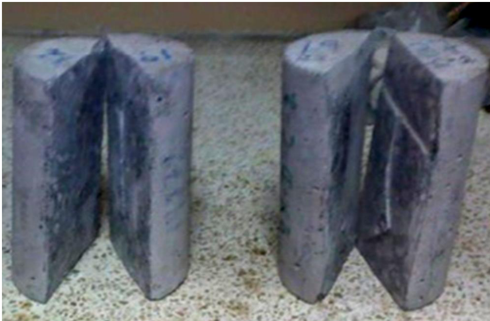
Figura 49. Corte de probetas para ensayo de avance de carbonatación.
