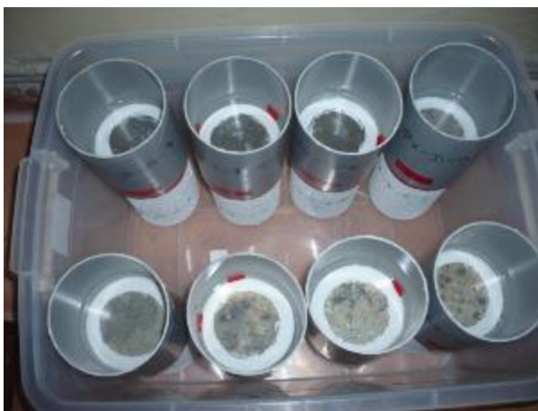
Figura 26. Probetas cilíndricas en proceso de difusión de solución de NaCl. Fuente: Autor.
