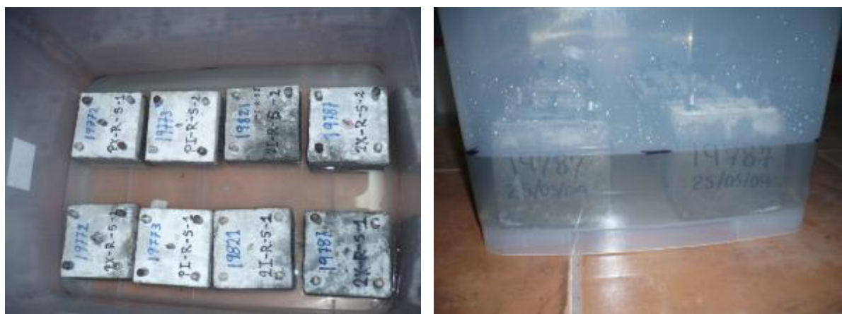
Figura 25. Probetas cúbicas en inmersión en solución de NaCl.
