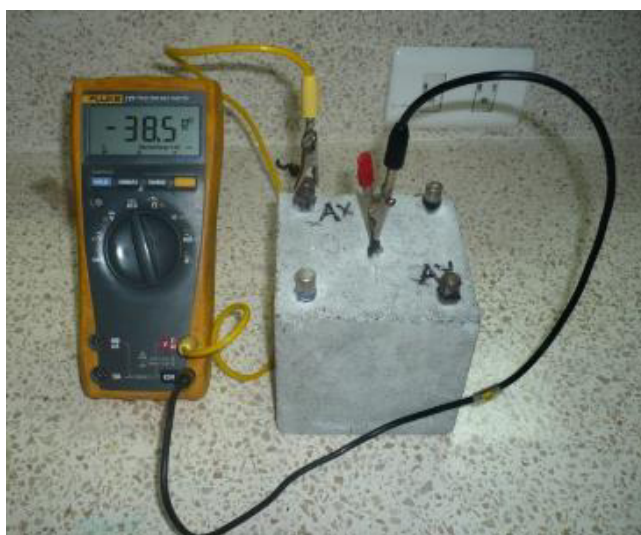
Figura 32. Medición de Potencial de Corrosión E_{corr} . Fuente: Autor.
