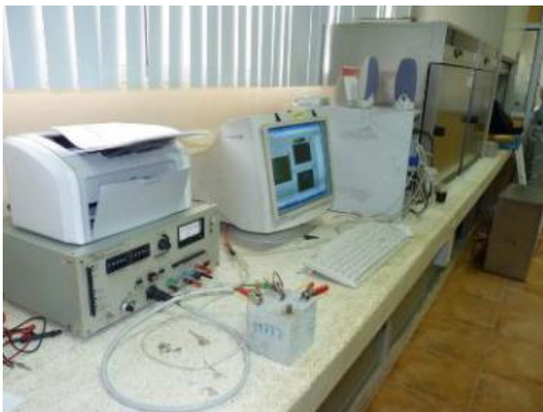
Figura 34. Potencio-Galvanostato EG&G modelo 362 y sistema de adquisición de datos. Fuente: Autor.
