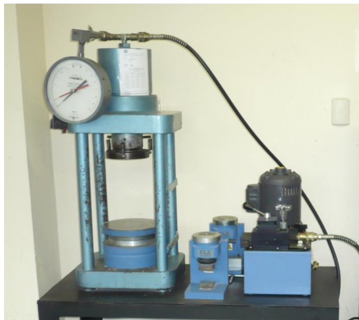
Figura 27. Banco de pruebas para ensayos de rotura. Fuente: Autor.
