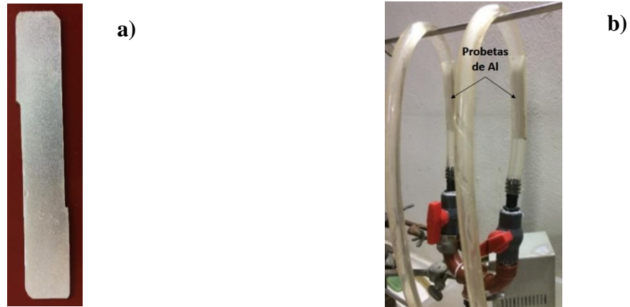
Figura 2.21. a) Aspecto de la probeta utilizada en los ensayos de oxidación a diferentes velocidades de circulación de agua. b) Montaje de la probeta en el equipo de recirculación.
