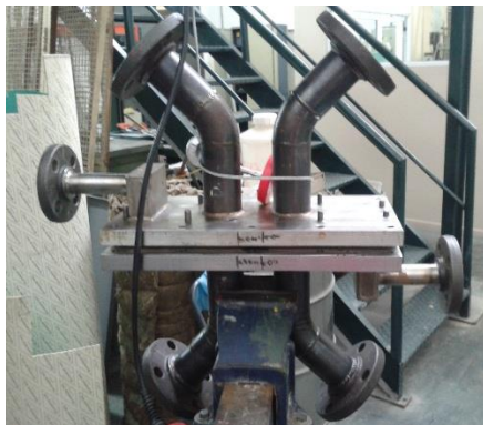
Figura 7.3. a) Montaje de segundo PortaPlaca. b) Ajuste de los tornillos.
