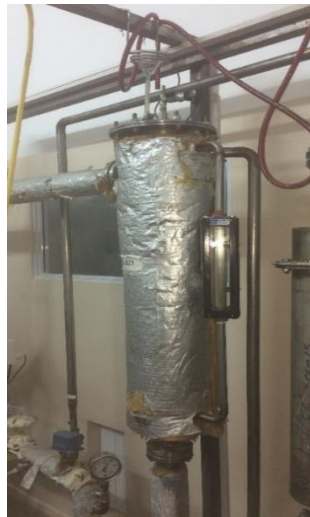
Figura 2.7. a) Vista del tanque expansor del circuito de agua. b) Vista de la columna de purificación.
