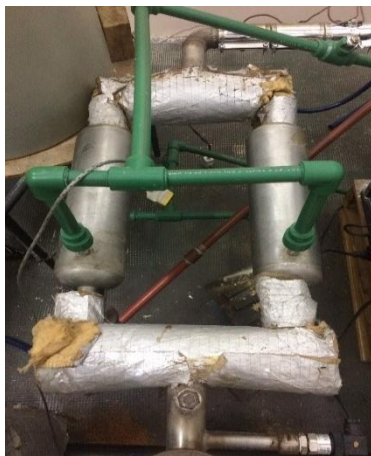
Figura 2.8. a) Vista de los intercambiadores doble tubo. b) Baño termostático.
