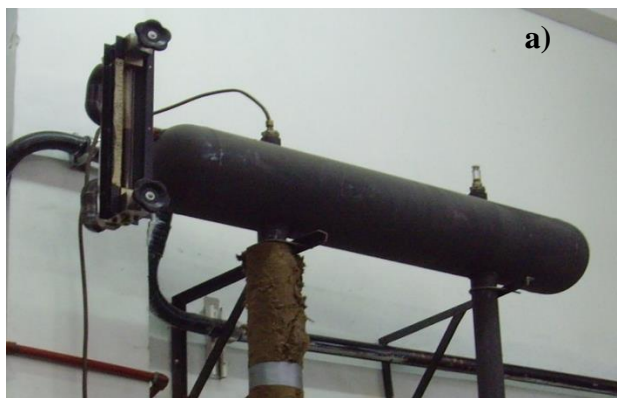
Figura 2.4. a) Tanque expansor de fluido térmico. b) Tubo de N 2 .
