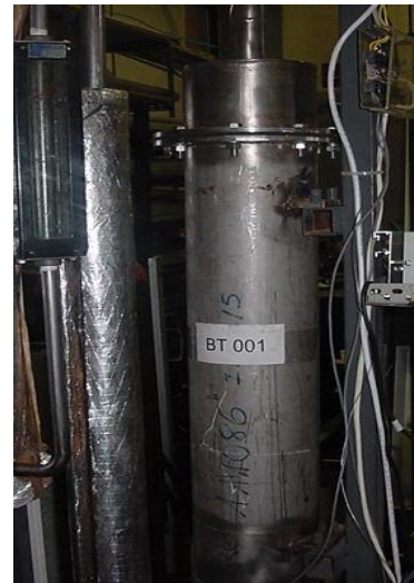
Figura 2.7. a) Vista del tanque expansor del circuito de agua. b) Vista de la columna de purificación.
