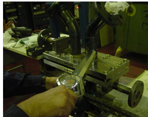
Figura 7.3. a) Montaje de segundo PortaPlaca. b) Ajuste de los tornillos.
