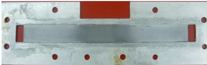
Figura 3.35: Aspecto de la placa A2 la cual fue ensayada en forma discontinua por cinco meses, con dos paradas intermedias.
