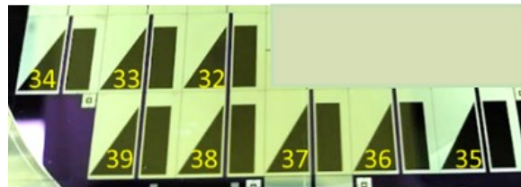
Figura 4.20. Detectores con fotodiodos triangular y referencia rectangular, difusión 389.
