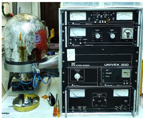
Figura 3.19. Evaporadora marca Leybold-Heraeus modelo Univex 300.
