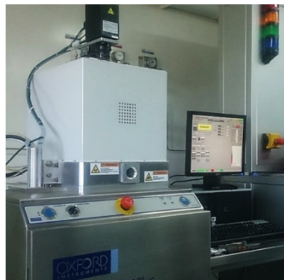
Figura 3.15. RIE Plasmalab 80 Plus de Oxford Instruments, Sala Limpia del DMNT.
