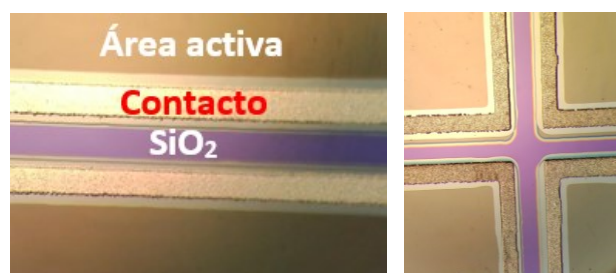
Figura 3.28. Contactos de cada fotodiodo y barrera de SiO 2 de un detector.
