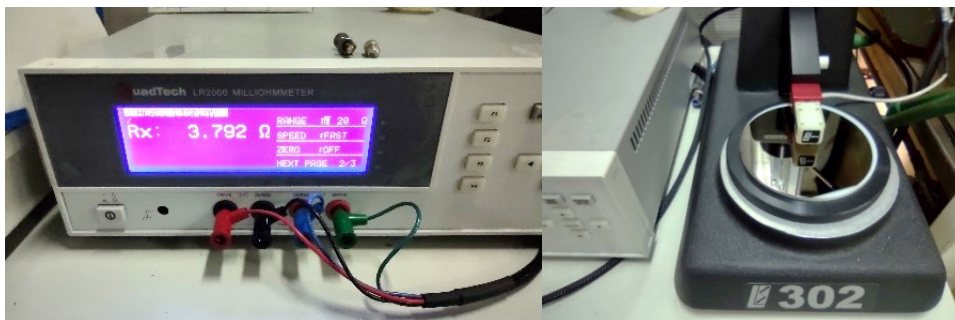
Figura 3.23. Equipamiento para la medición de resistencia de capa.
