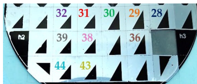
Figura 4.17. Fotodiodos triangulares, difusión 387.
