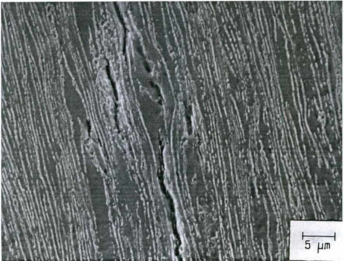
Figura 2. Metalografía de una muestra de Zr-2.5%Nb de un tubo de presión.
