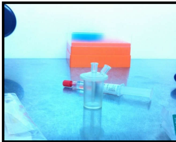
Figura 6. Vial reactor donde se coloca el precursor.
