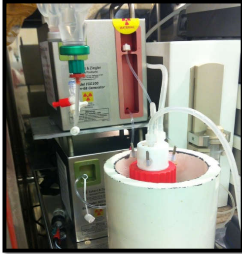
Figura 2 Generador conectado en serie con un segundo generador.
