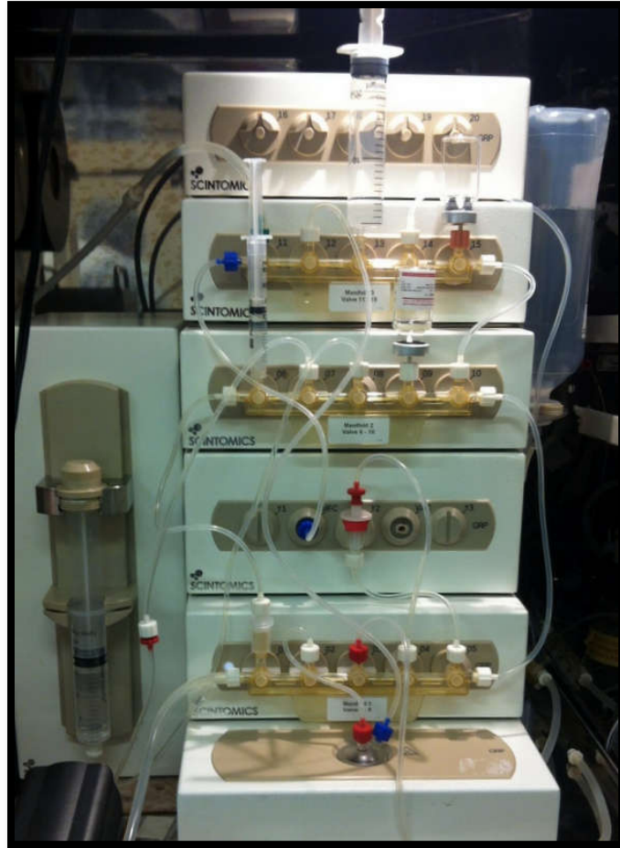
Figura 4. Módulo de síntesis con sus respectivas columnas y reactivos
