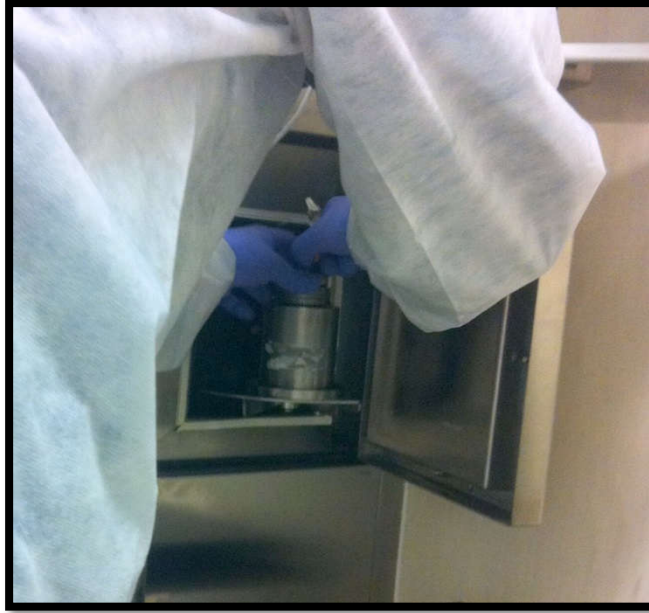
Figura 5. Vial con blindaje colocado dentro del compartimiento blindado.
