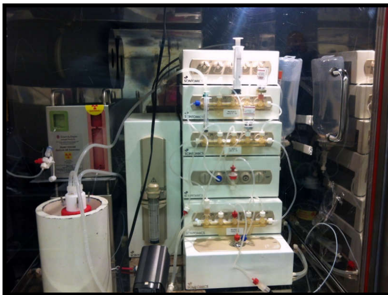
Figura 7. Generador conectado al módulo de síntesis, con su puerta de vidrio blindado a presión.
