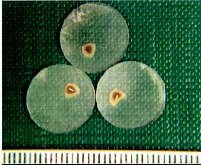
Figura 2.9 – b: Muestras de aproximadamente 500 \mu\text{m} de espesor, luego de cortes transversales al eje mayor de la tibia.
