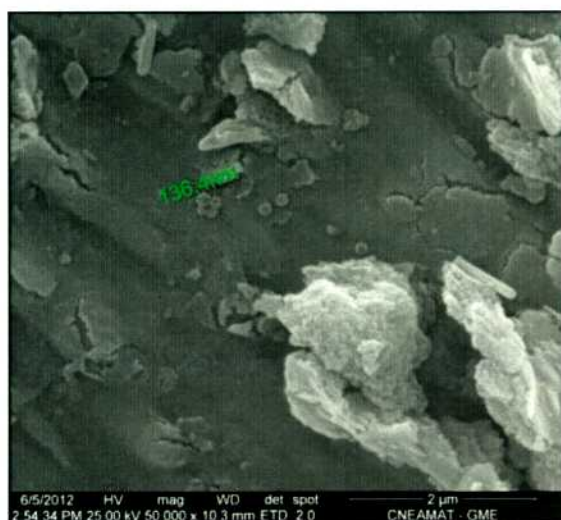
Figura 3.16: Probeta anodizada a 60V, luego de estar incubada 24 horas en SBF. Se observa la presencia de pequeñas esferas.
