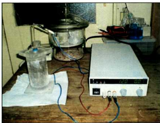
Figura 2.2: Celda de anodizado utilizada junto con la fuente de voltaje.
