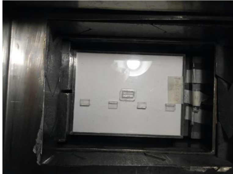
Figura 23. Vista superior de Blindaje N° 2 con tapa, inserto en la cavidad portamuestras de la FCCT.
