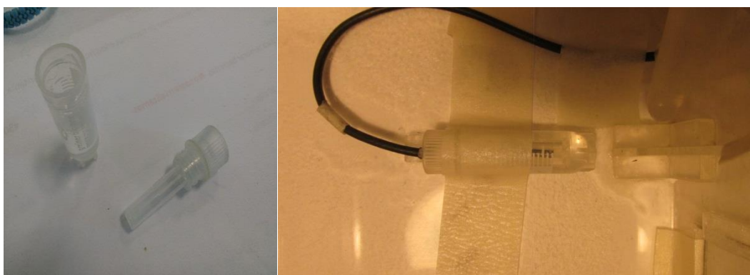
Figura 25. Se observa a la izquierda criotubo modificado y en la parte derecha el SPND inserto dentro del mismo en la configuración Blindaje N° 2.
