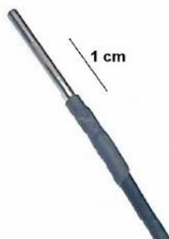
Figura 1. Fotografía de un detector SPND. En ella pueden observarse las vainas externas del sistema: la vaina de Zircaloy-4, en el cuerpo del detector; la vaina termocontraíble, cubriendo la conexión cable-detector; y la vaina aislante del cable. También se puede apreciar una escala que denota las dimensiones del detector.
