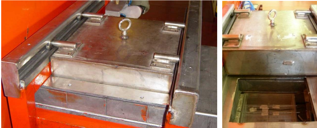
Figura 4. Puerta blindaje de acceso a la cavidad porta muestras. Ésta se desplaza lateralmente para introducir o extraer las muestras de dicha cavidad.
