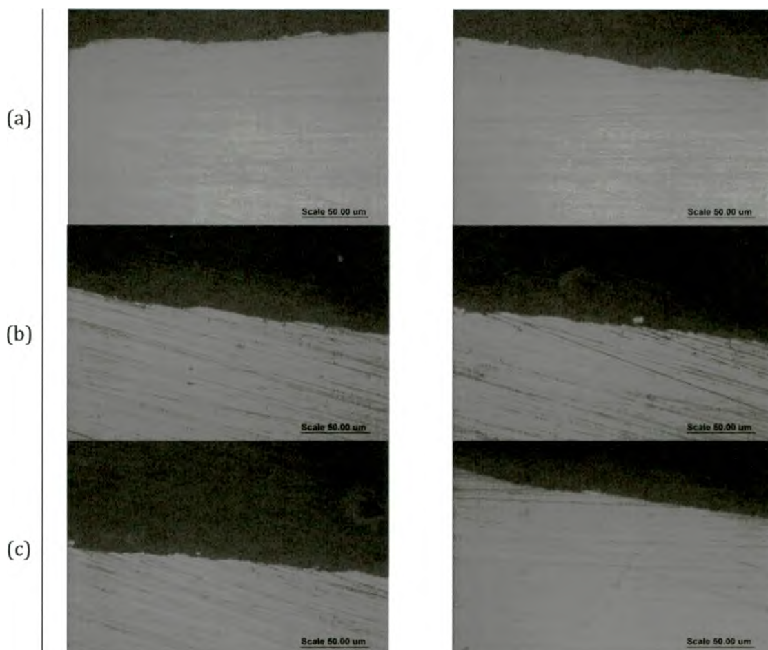
Figura 4.70: Micrografías de las probetas de tracción de la aleación 201 incluidas y pulida longitudinalmente, luego de realizado el ensayo en 1,148 \text{NaHCO}_3 a 90^\circ\text{C} y a (a) 200\text{ mV}_{\text{ECS}} , (b) 300\text{ mV}_{\text{ECS}} y (c) 400\text{ mV}_{\text{ECS}} .
