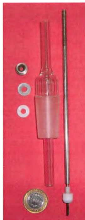
Figura 3.2: Imagen y esquema del electrodo de trabajo armado y sus componentes
