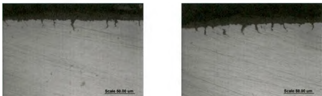
Figura 4.58: Micrografías de la probeta de tracción de la aleación 600 incluidas y pulida longitudinalmente, luego de realizado el ensayo en 1,148 \text{NaHCO}_3 a 90^\circ\text{C} y a 200 \text{ mV}_{\text{ECS}} .
