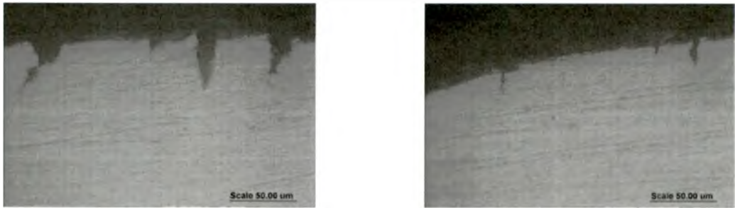
Figura 4.108: Micrografías de la probeta de tracción de la aleación C-22 incluida y pulida longitudinalmente, luego de realizado el ensayo en 0,05 mol/L \text{Na}_2\text{B}_4\text{O}_7 \cdot 10\text{H}_2\text{O} (pH: 10) a 90°C y a 400mV ECS .
