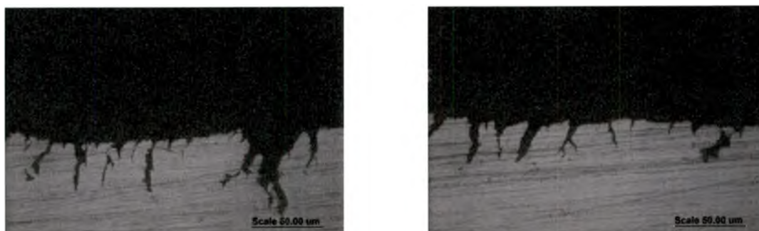
Figura 4.52: Micrografías de la probeta de tracción de la aleación C-22 incluida y pulida longitudinalmente, luego de realizado el ensayo en 1,148 \text{NaHCO}_3 a 90^\circ\text{C} y a 200\text{ mV}_{\text{ECS}} .
