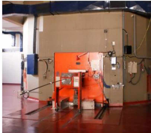
Figura 3-3 Vista externa de la FCCT donde se observa el dispositivo para el ingreso y extracción de muestras, con detalle en el tubo hueco utilizado para desplazar la bandeja porta muestras hacia y desde la posición de irradiación.
