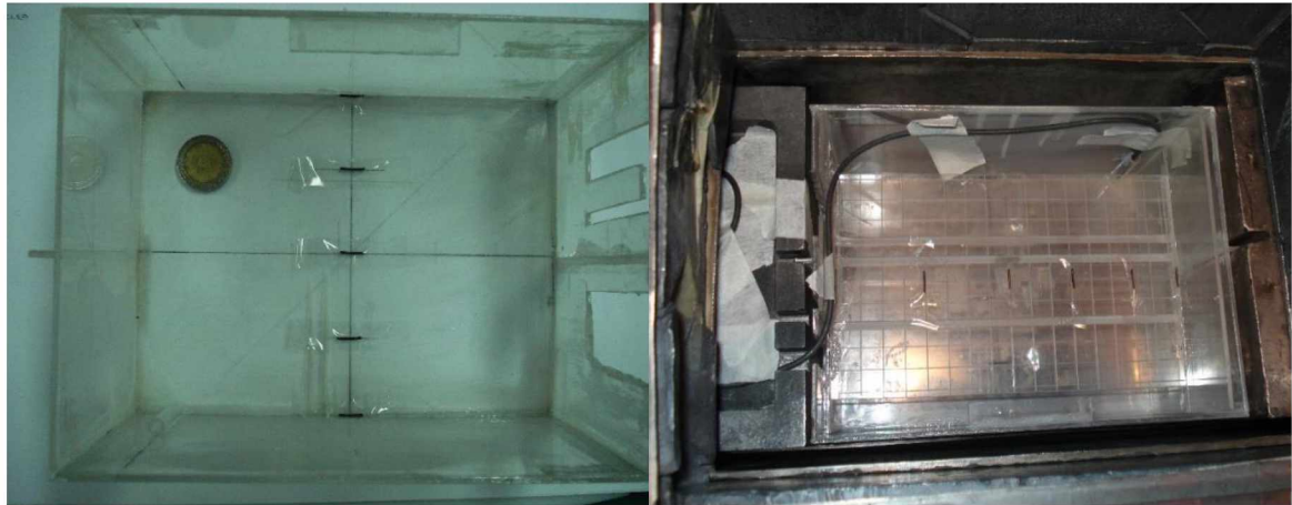
Figura 3-12 a) Vista superior de la caja de acrílico con los alambres detectores posicionados en sentido transversal sobre la línea media de la misma; el núcleo del reactor se encontraría a la izquierda de la imagen. b) Vista superior de la caja de acrílico con el dispositivo en "H" colocado, posicionada en la cavidad de irradiación. Se observan los alambres detectores en posición longitudinal junto con los SPNDs de referencia y monitor.
