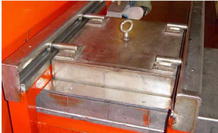
Figura 3-5 Tapa deslizable de plomo recubierta de acero. Esta tapa permite el acceso a la cavidad porta muestras para la inserción y extracción de las muestras a irradiar.
