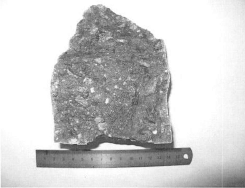
Figura 4.29. Probeta formulada con CAH + SF, donde se puede observar que el espesor de carbonatación es despreciable luego de 1072 días (3,30 años) de exposición.
