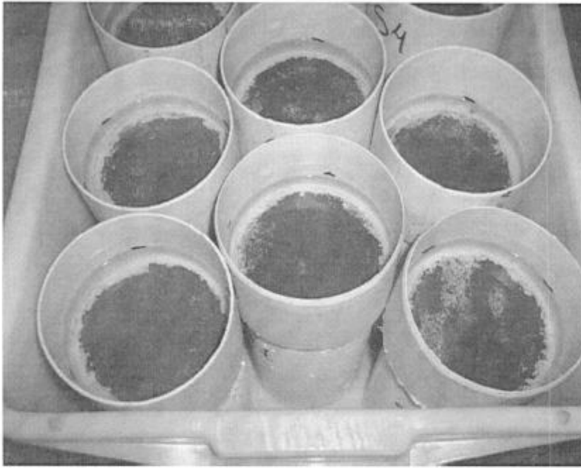
Figura 3.6. Imagen de las probetas pintadas, armadas y con la solución de NaCl 3% m/m.
