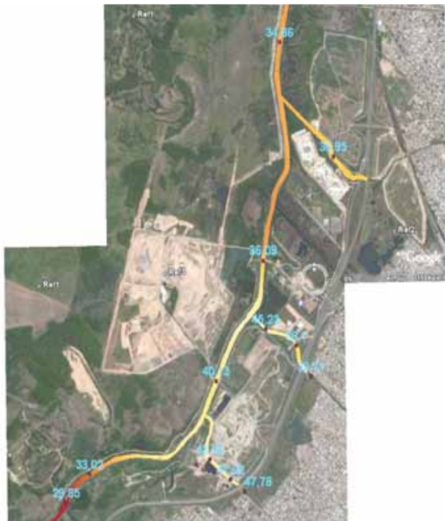
Figura 6. Aplicación del Índice de Calidad de Agua adoptado por el proyecto RLA/1/010 al sistema en estudio. Los valores muestran una pobre (0 a 44) o marginal (45 a 64) calidad del agua.
