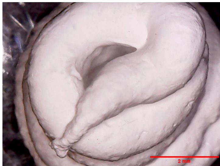
Figura 3.15: Aspecto microscópico después del fraguado, superficie de la pasta C4 extrudada con jeringa. Puede notarse una superficie irregular.
