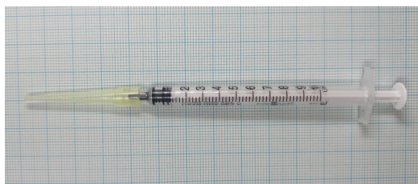
Figura 2.2: Cartucho de impresión. Jeringa de 1 ml con boquilla de 1 mm.
