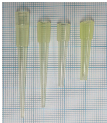
Figura 2.1: Boquillas de impresión, distintos diámetros internos. De izquierda a derecha: Tip para micropipeta de 200 \mu l nuevo, boquilla de 1 mm, boquilla de 2 mm y boquilla de 2,5 mm.
