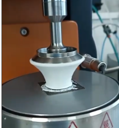
Figura 3.7: Ensayo reológico con variación de velocidad de mezclado, etapa de mezclado a 120 RPM. Puede notarse material despedido de la geometría por la velocidad del ensayo.
