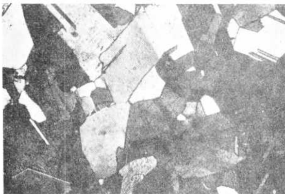
Fig. 25. - Muestra de latón 70/30 pulido electrolíticamente y sulfurado anódicamente por el método del tampón. Capas epitáxicas delgadas. Los diferentes grises corresponden a diferencia de colores de interferencia. x 400
