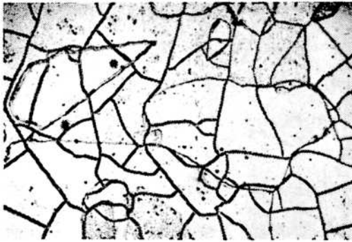
Fig. 6. - Muestra de aleación de Al con 0,2% Cr. ensayada por espresio de 6 hs. a 250°C en agua a presión. Pulida electrofíticamente en el baño acetoperclórico de Jacquet. Corrosión intergranular. x 80
