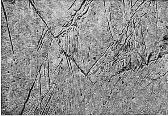
Fig. 17. - Zinc de pureza 99,99% fuertemente maclado. x 150
