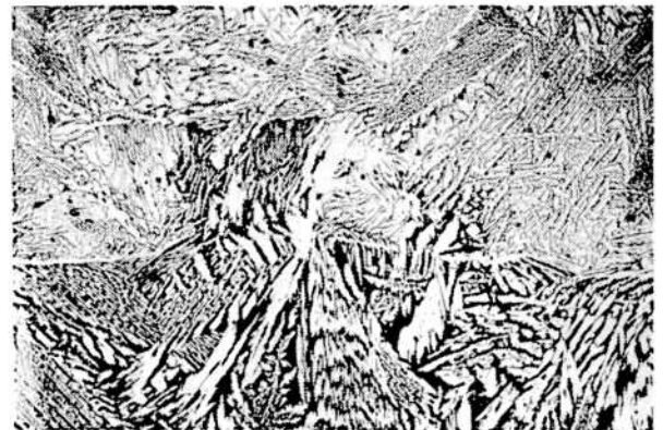
Fig. 12. - Estructura de fundición de metal Munz. x 150
