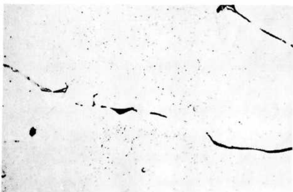
Fig. 15. - Aleación de Al-Mg-Si utilizada en los elementos combustibles RA-1. La fase precipitada es Mg_2Si . x 500
