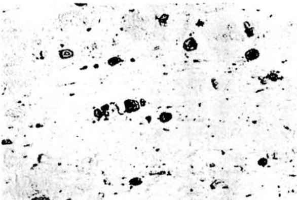
Fig. 11. - Cobre tough pitch laminado en frío. Partículas de \text{Cu}_2\text{O} en matriz deformada. x 400
