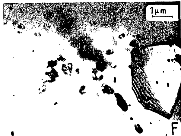
FIG. 28 Autoradiographies à haute résolution du tritium sur lames minces observées à 1000 kV. Acier Z 5 CNT 18-10, chargé en tritium à -20\text{mA/cm}^2 . A à F : piégeage sur les dislocations, joints de grains et joints de macle. Absence de piégeage sur les précipités TiC.
