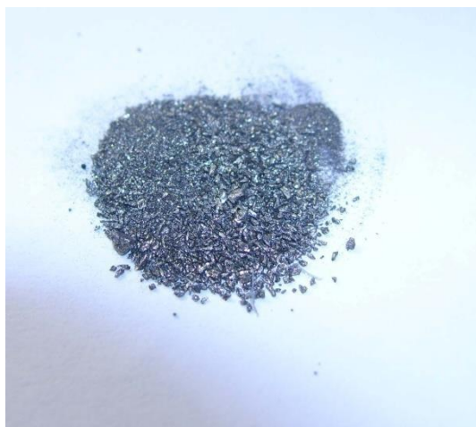
Figura III-1. Botón pulverizado de Aleación U_3Si_5
