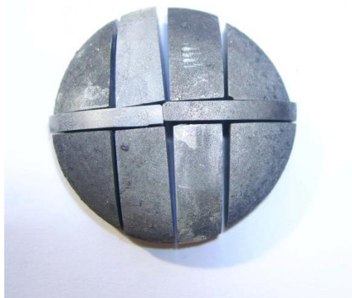
Figura III-2. Botón seccionado de aleación Al_{43}Mo_4U_6
