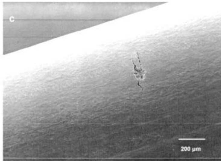
Figura 3.20: Superficies laterales de alambres de Zircaloy-4 traccionados en diferentes soluciones (todas de concentración 10 g/L de yodo): a) etanol + 10% agua; b) 1- propanol + 1% agua; c) 1-octanol + 1% agua. En todos los casos las fisuras son de tipo intergranular.
