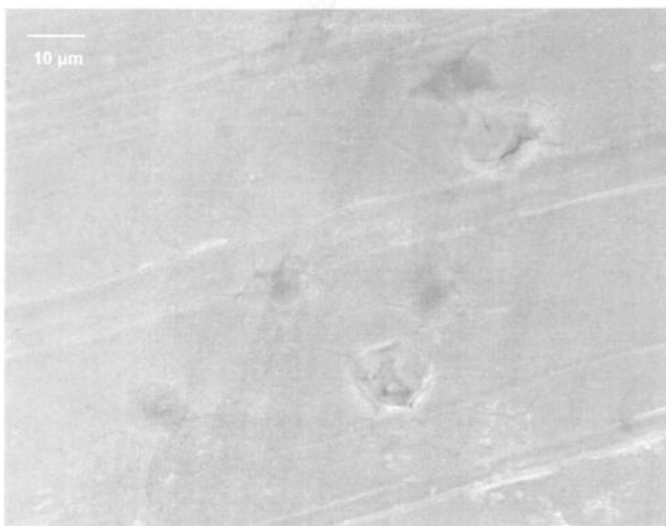
Figura 3.35: Superficie lateral de Zircaloy-4 luego de ser sumergido en solución de 10 g/L de yodo en metanol durante 8 h. En a) apenas se distinguen pequeños pits (puntos oscuros). b) es un detalle de algunos de esos pits, que resultan ser zonas con ataque intergranular. También se distinguen los bordes de grano.
