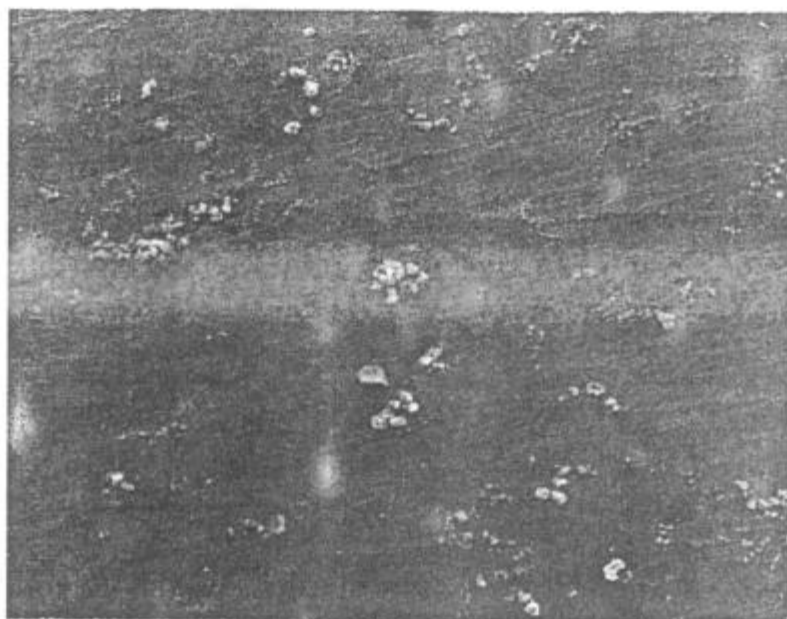
Figura 3.1.7.-Superficie de una probeta después de haber sido polarizada anódicamente en solución saturada de \text{Ca(OH)}_2 . Se puede apreciar el “mill scale” intacto, así como algunos precipitados blancos presuntamente de \text{Ca(OH)}_2 (x 200).
