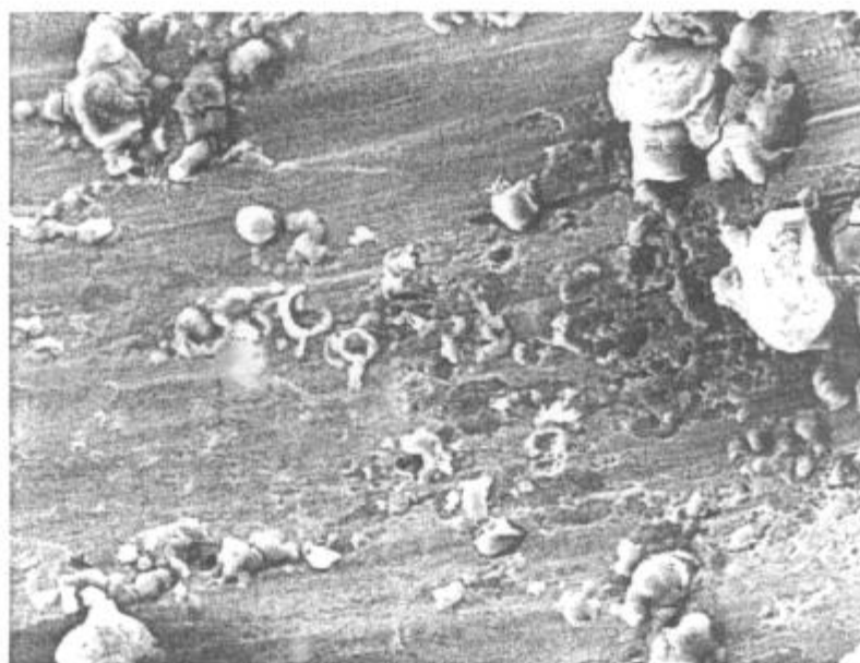
Figura 3.1.12.-Morfología del ataque observado en la probeta después de haber sido polarizada anódicamente en solución \text{NaHCO}_3 0,3 M + \text{Na}_2\text{CO}_3 0,1 M + 0,5 % \text{Cl}^- . Se aprecian picaduras pequeñas y productos de corrosión formando círculos cubriendo picaduras de gran tamaño (x 800).
