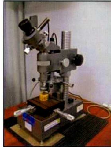
Figura 2.3. Microdurómetro utilizado para calcular la dureza de las probetas.
