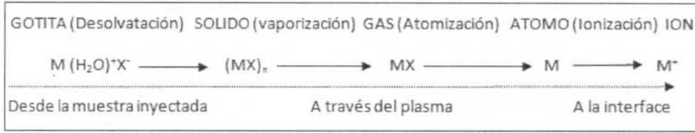
Figura 2.9. Mecanismo de conversión desde la gotita hasta el ion en el ICP.
