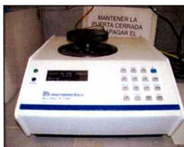
Figura 2.6. Equipo Micromeritics Accucyc II 1340, gas Pycnometer, utilizado para la medición de volúmenes.
