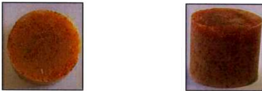
Figura 3.3. Probetas solidas resina de intercambio con resina epoxi y agregado de arcilla (bentonita), antes del proceso de pirólisis.
