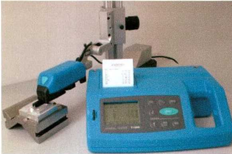
Fig.31/A. Perfilómetro Hommelwerke Tester T1000
