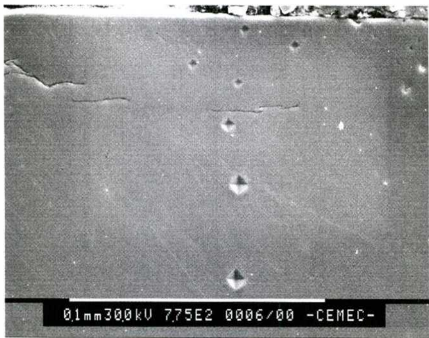
Fig.8/5. Sección de una muestra nitrurada durante 20 h a 400 °C. Improntas de microdureza Vickers
