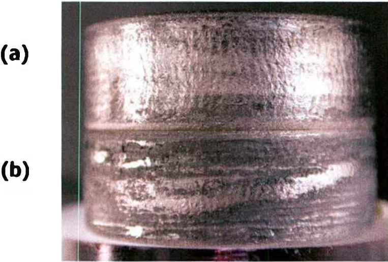
Fig.38/5. Imágenes de la superficie de las muestras no nitruradas luego del ensayo de desgaste con una carga aplicada de 200 kg: (a) muestra A16 y (b) muestra A15.
