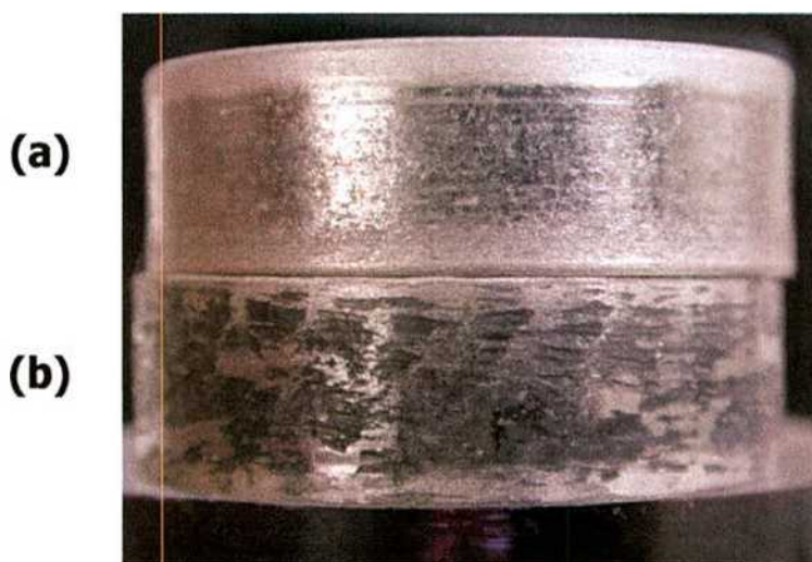
Fig.35/5. Imágenes de las muestras sin nitrurar luego del desgaste bajo una carga de 125 kg (a) muestra A8 y (b) muestra A7.
