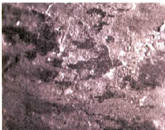
Fig.36/5. Imagen SM de la muestra A7 sin nitrurar luego del desgaste bajo una carga de 125 Kg
