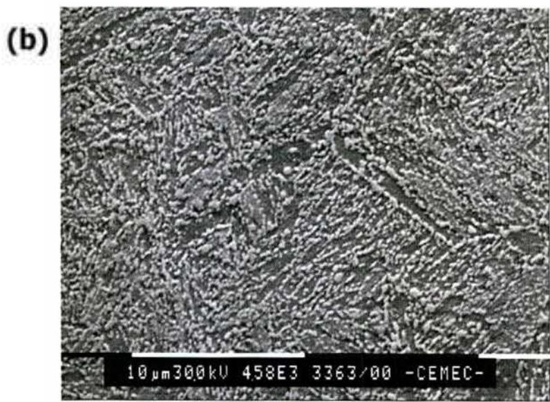
Fig.1/4. Micrografías SEM del sustrato, acero AISI 4140 templado y revenido.
