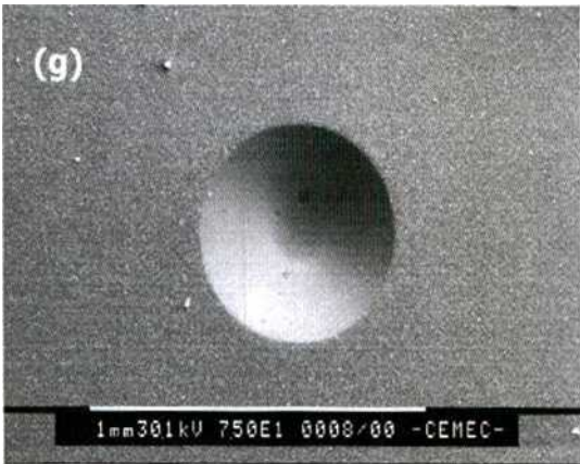
Fig.12/4. Imágenes SEM de improntas HRC realizadas en muestras de un acero AISI 4140 sin nitrurar (a) y nitrurado a 500 °C durante: (b) 1 h, (c) 2 h, (d) 4 h, (e) 15 h (f) 20 h y (g) 28 h
