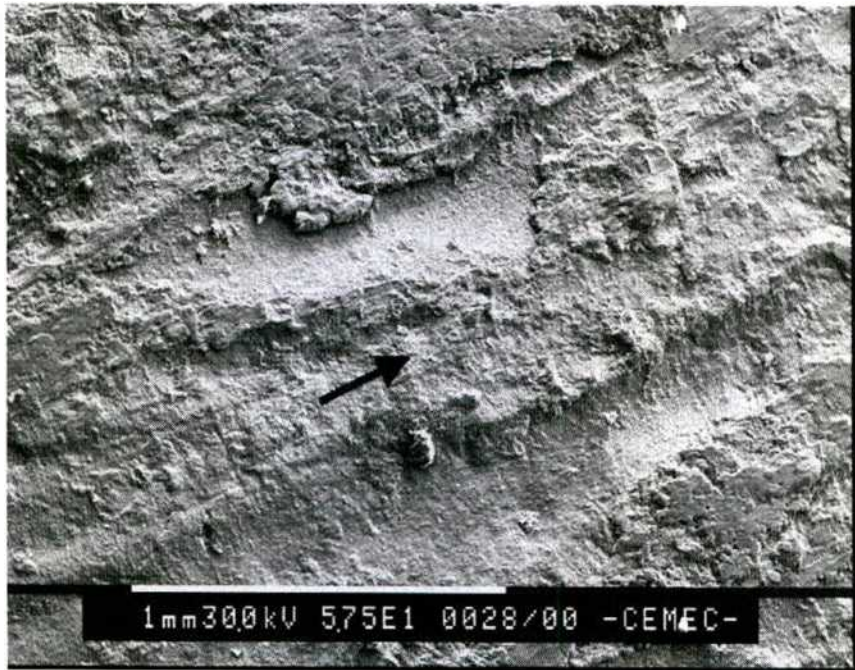
Fig.33/5. Imágenes SEM obtenidas en diferentes zonas y a diferentes magnificaciones de la superficie de muestra A1 luego del ensayo de desgaste.
