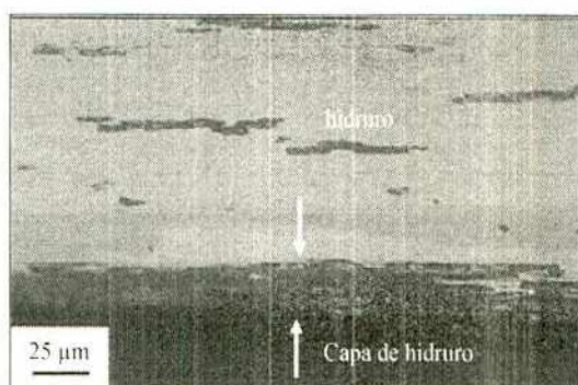
Figura 6.2. Micrografía de Zr-2,5Nb luego de una carga gaseosa con hidrógeno. En la superficie se observa la capa de hidruro formada, y hacia el interior algunos hidruros precipitados.
