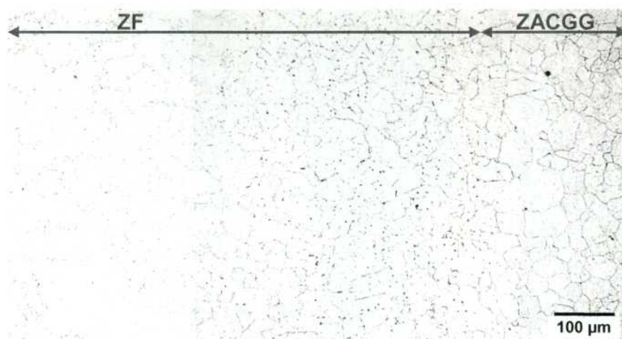
Figura 4.69. Micrografía óptica ataque con oxálico: límite entre la ZF y la ZACGG.
