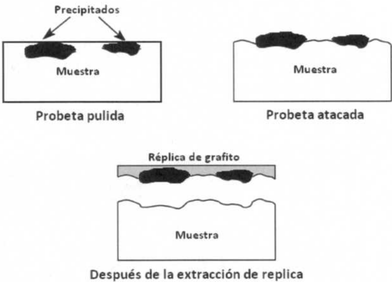
Figura 3.8. Diagrama esquemático que ilustra la preparación de réplicas extractivas [10].
