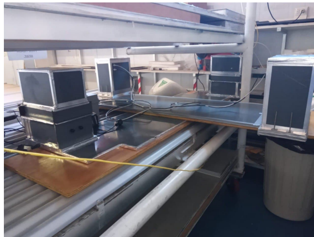
FIGURA 3.24: Imagen de los dos módulos prototipo cruzados para medir en coincidencia (imagen tomada en septiembre 2021), actualmente estamos trabajando en el formato de los datos para poder tener un análisis eficiente, para poder construir las imágenes usando la técnica de muongrafía es requerido contar y reconstruir la trayectoria de los muones.
