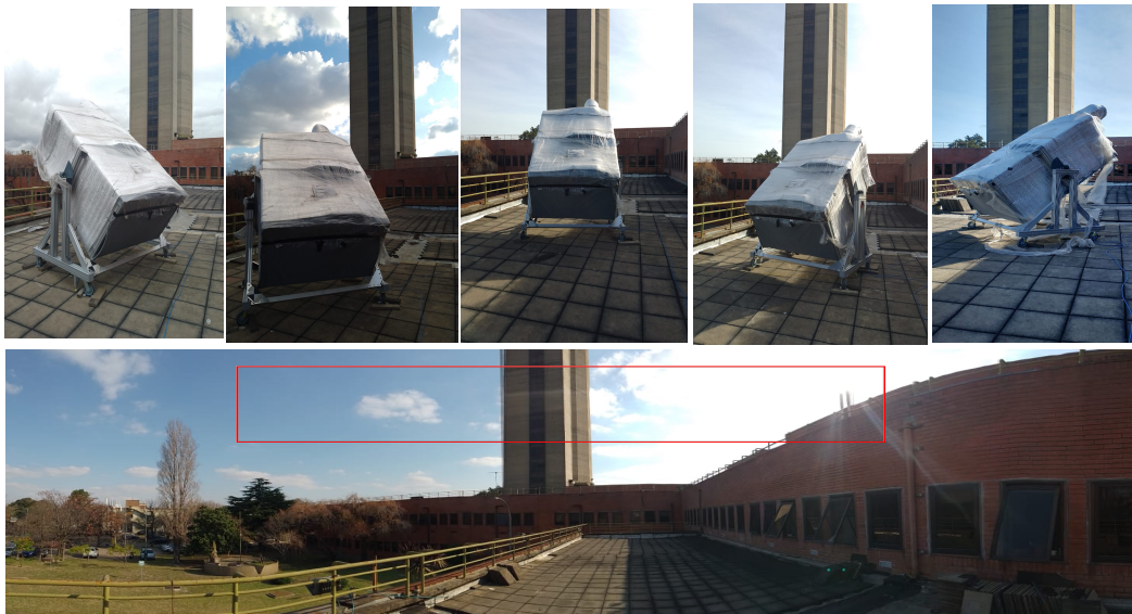
FIGURA 5.12: Posiciones del detector haciendo un barrido horizontal, cada posición estuvo adquiriendo durante una semana. En recuadro rojo, el campo de visión del detector.
