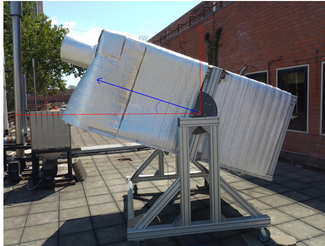
FIGURA 5.8: Medición del flujo cada 10^\circ desde el cenit hasta el horizonte, esta medición fue realizada a 40 m.s.n.m en Buenos Aires y constituye la primera medición del flujo direccional en esta latitud. La forma funcional corresponde con la teoría y es debido a la convolución de efectos como la forma de la atmósfera, el flujo de muones y la morfología del detector.
