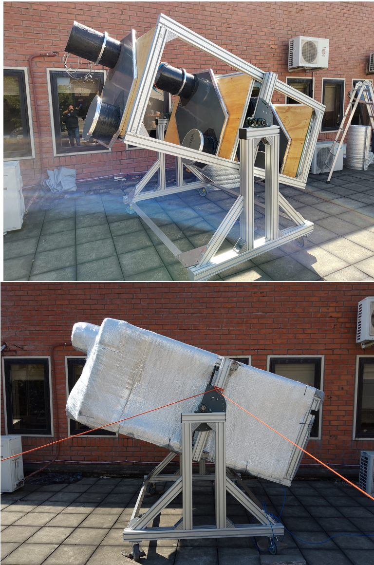
FIGURA 3.39: Arriba se muestra en la fotografía el detector montado afueras sin el recubrimiento térmico. Para las mediciones se utilizó un recubrimiento térmico de manera que no se calienten los paneles, además de la lluvia, humedad, condiciones de viento y cambios térmicos. La estructura puede cambiar su posición angular de 0 a 180 grados. Abajo se presenta una fotografía con la cubierta terminada.
