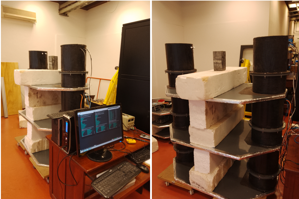
FIGURA 5.4: A la izquierda se presenta el detector montado en el laboratorio para las primeras mediciones usando un bloque de plomo de referencia. Inicialmente se utiliza un computador de escritorio como servidor. A la derecha el mismo detector desde otro ángulo, se observan los tres paneles en gris, las galerías negras de los costados son de material plástico y protegen la electrónica de adquisición de la luz.
