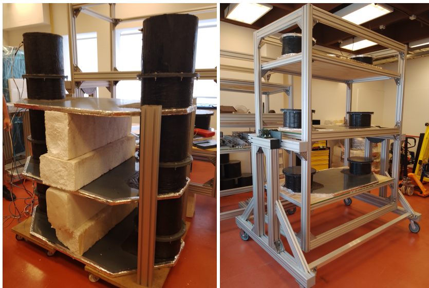
FIGURA 3.36: A la izquierda una fotografía de los paneles en las primeras pruebas de calibración midiendo en coincidencia. Este montaje no tenía la estructura mecánica. A la derecha fotografía de la estructura con los tres paneles construida en ITeDA-CAC finales de 2022, la estructura esta diseñada para tener varios paneles móviles, simétricos y sincronizados.
