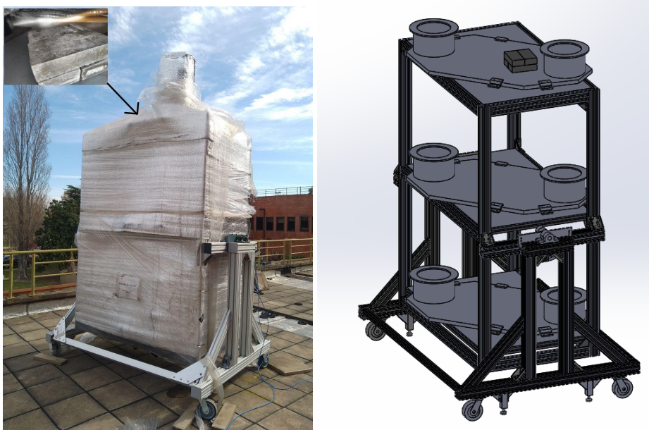
FIGURA 5.9: A la izquierda foto del detector en posición vertical adquiriendo datos con un bloque de plomo de referencia encima del plano superior. Los paneles están separados 1 m entre ellos. A la derecha un diseño de la estructura con la misma posición indicando la ubicación del plomo, son 4 bloques rectangulares de plomo con una geometría total de ( 20\text{cm} \times 20\text{cm} \times 10\text{cm} ).
