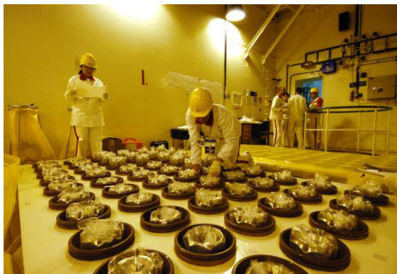
Inspectores de “salvaguardias” verificando EECC gastados en un almacenamiento de reactores de investigación.
