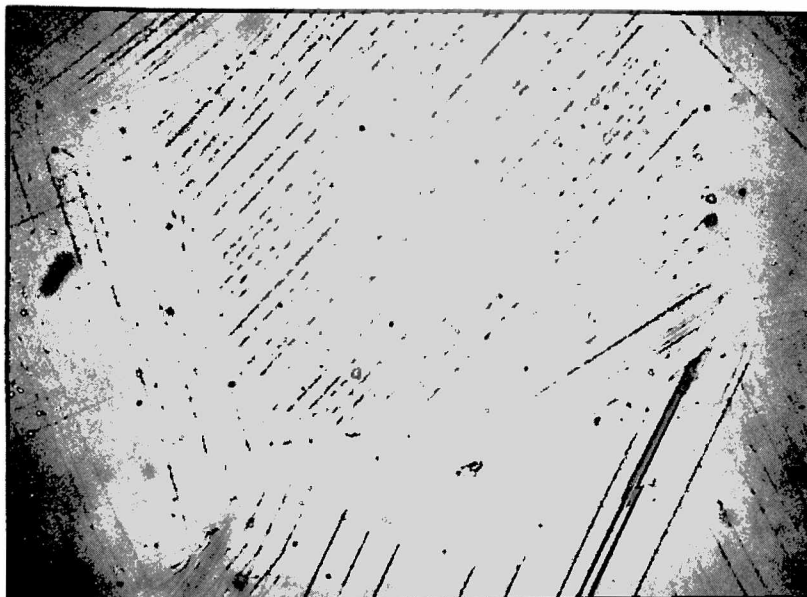
Fig. 1a - Martensita "termoelástica" en una probeta policristalina, 88 x
