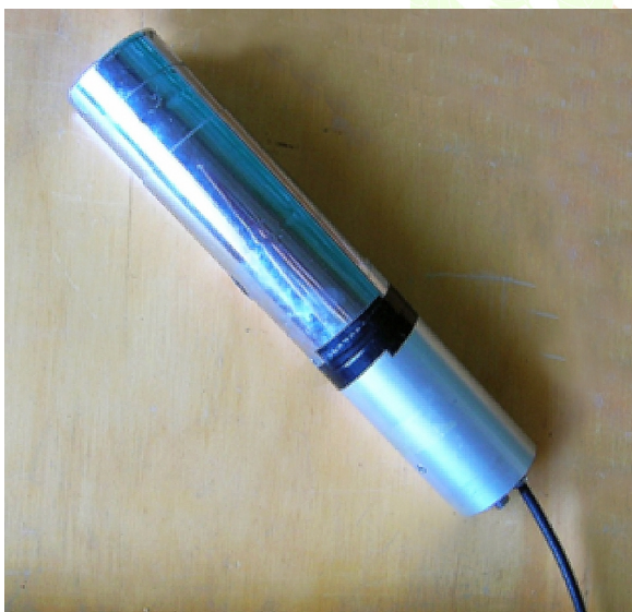
Fig. 2 – Centellador NaI - Radiómetro de yoduro de sodio dopado con talio. Siempre lleva adosado un sensor de luz y una electrónica asociada.
