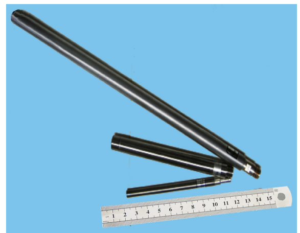
Fig. 1 – Tres modelos de detectores cilíndricos conteniendo helio-3 que se utilizan para detectar neutrones lentos.
