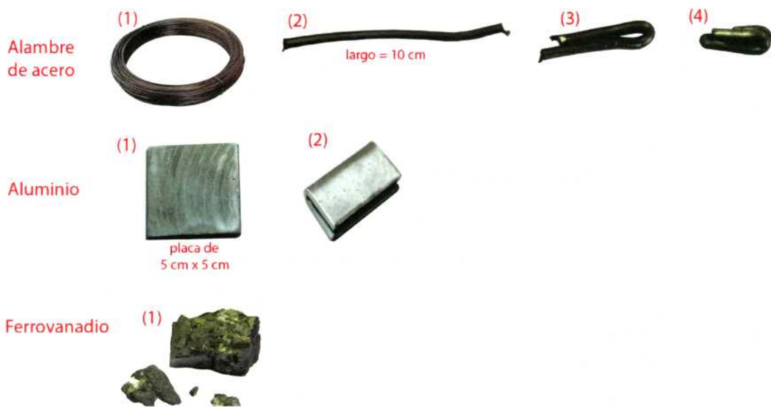
Figura 2.3 Etapas para la preparación de materias primas antes de su disposición en el crisol.
