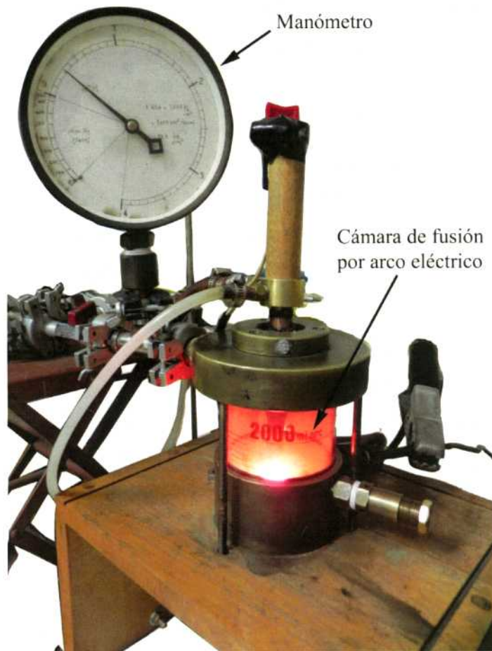
Figura 2.1 Sistema de fusión por arco eléctrico.
