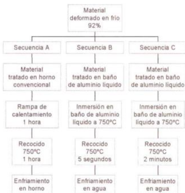
Figura 7.28. Esquema de tratamientos térmicos aplicados sobre material deformado en frío 92%
