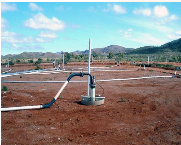
Minería del uranio por lixiviación in situ (Beverley - Australia).
