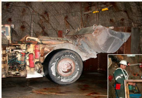
Extracción de uranio por minería subterránea (Mc Arthur River - Canadá). Vehículo operado a control remoto.
