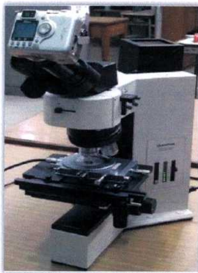
Figura 4.2 Microscopio equipado con polarizadores, cámara digital y platina calefaccionada.
