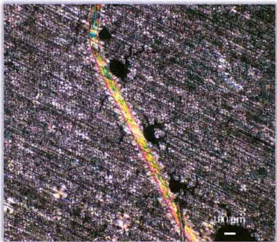
Figura 5.9 Morfología desarrollada en muestras de PHBV con fibra de cáñamo cristalizadas en aire.
