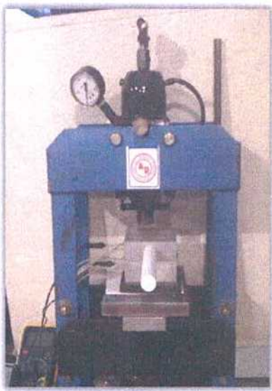
Figura 4.1 Lingotes de metal con calefactores embutidos ubicados dentro de una prensa hidráulica.
