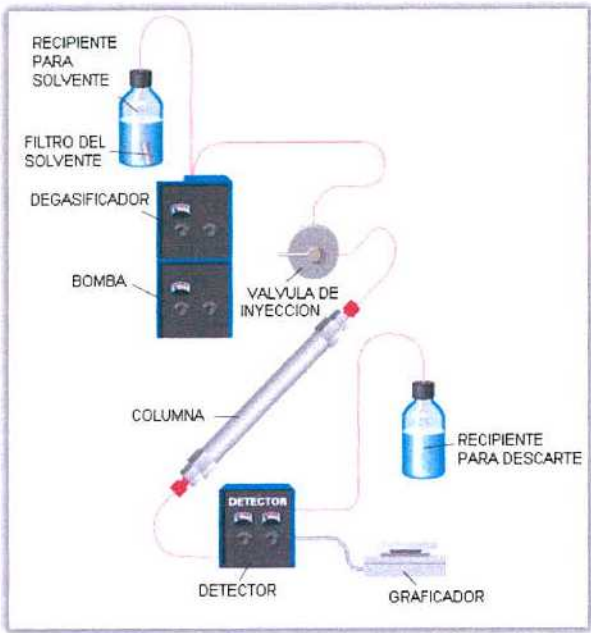
Figura 4.8 Esquema del equipo de HPLC utilizado para obtener la distribución de pesos de muestras de PHBV irradiadas a diferentes dosis.
