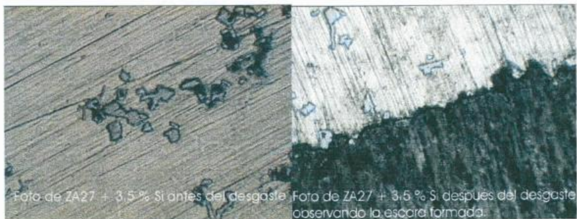
Figura 6-25 Izquierda superficie de la muestra antes de ser desgastada, derecha escara formada por el disco al entrar a la muestra.
