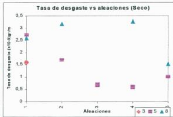
Figura 6-36 Pérdida de peso vs aleaciones (Seco) 1) ZA27, 2) ZA27 + 3,5%Si, 3) ZA27 + 3,5%Si + 1%Cu, 4) ZA27 + 3,5%Si + 1%Cu + 8%SiC, 5) ZA27 + 3,5%Si + 1%Cu + 16%SiC.
