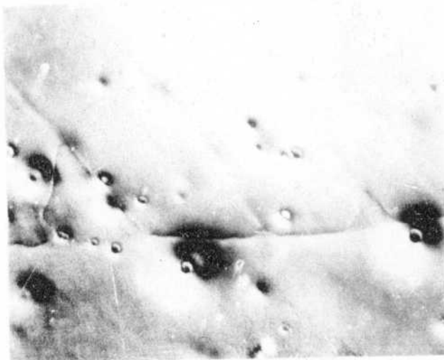
Figure 8.- Al déformé par traction 30% et recuit 24 h à 300°C. Croissance induite le long des bandes de pliage. CFIN G= 330
