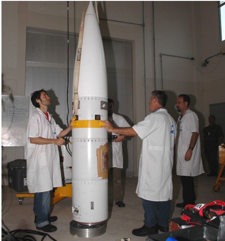
Figura 5.11. Cohete VS-30 durante la integración del mismo. Se observan sobre la franja amarilla dos de los arreglos de sensores de posición provistos por el DES para la orientación de la aeronave.
