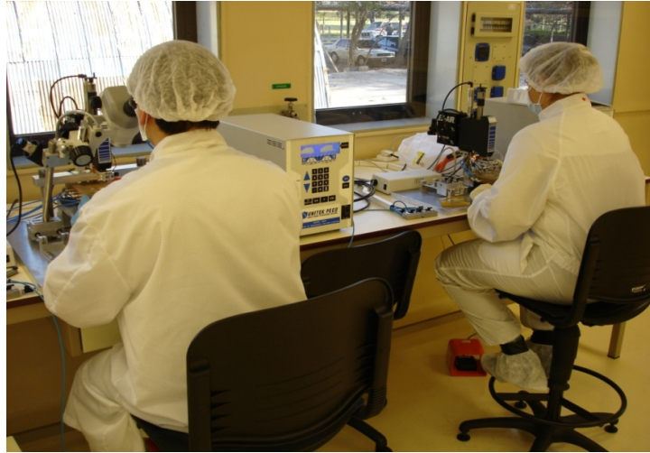
Figura 5.4. Estaciones de soldado de interconectores a las celdas mediante welding y soldering (soldadura frontal y posterior respectivamente)
