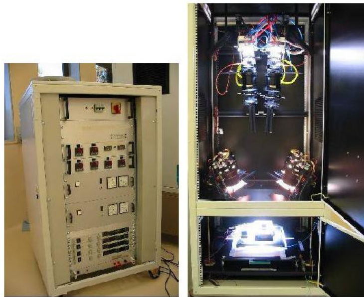
Figura 4.4. Simulador solar continuo TS-Space con espectro “close match AM0” utilizado en el laboratorio de integración de paneles solares del DES para la medición de celdas y cadenas de celdas bajo estándar espacial. Izq: fuente de alimentación y electrónica de control de las lámparas, der: interior del simulador y base termostatzada para medición.
