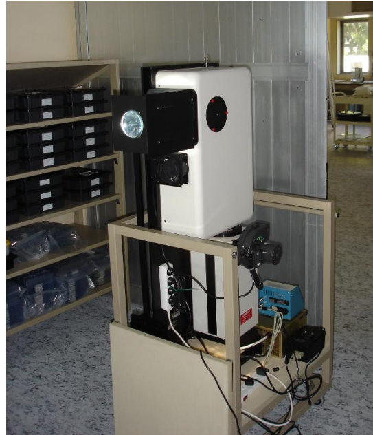
Figura 5.13. Simulador solar Sciencetech SS1kW con haz de salida acondicionado mediante una lente convergente; la fuente de luz sostiene un tamaño aparente de 2^\circ .
