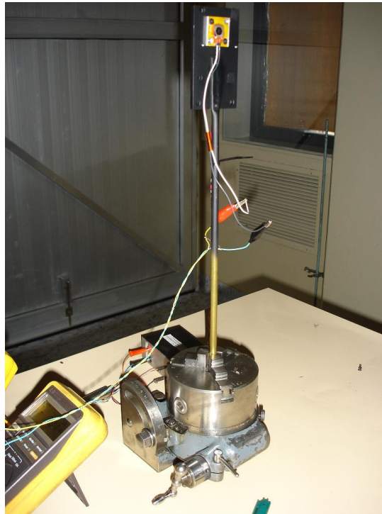
Figura 5.12. Sensor de posición montado sobre el disco rotante graduado; la resolución de posición del cursor es de 0,5^\circ .
