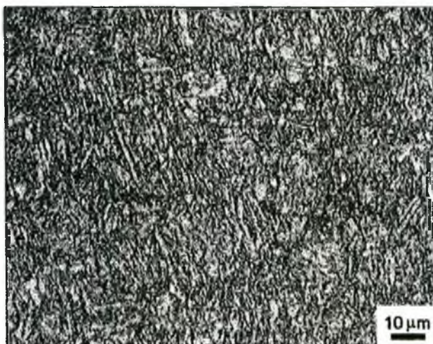
Fig. VI.16. Estructura martensítica original 50 x
